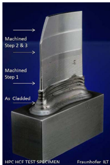
Figur 4. Turbinblad för flygplansmotor tillverkad med LMD.
