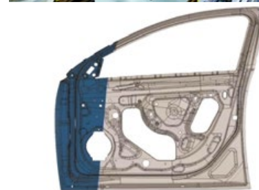
Figur 17. Interiörbild från en av Shilohs ämnesskarvningsanläggningar, och därjämte en ämnesskarvad sidodörrsstruktur i AA5182-0.
