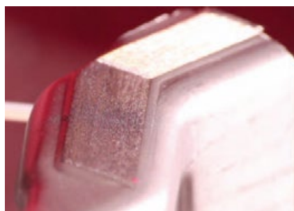
Figur 4. De med rött markerade områdena på sätets metalldelar strukturerades med 500 W lasereffekt enligt principen nedan t.h. innan dessa fogades till sätesgavlarna i glasfiberförstärkt polyamid.
