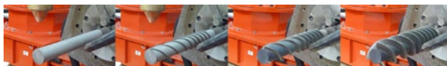
Figur 3. Matarskruv tillverkad av Inconel 625 på stålaxel med LMD.
