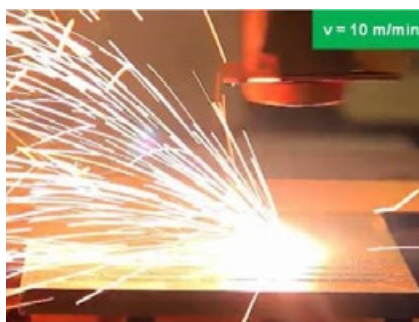
Bild 1. Sprutkaraktär vid delvis penetrerad fog vid en matningshastighet på 10 m/min.
