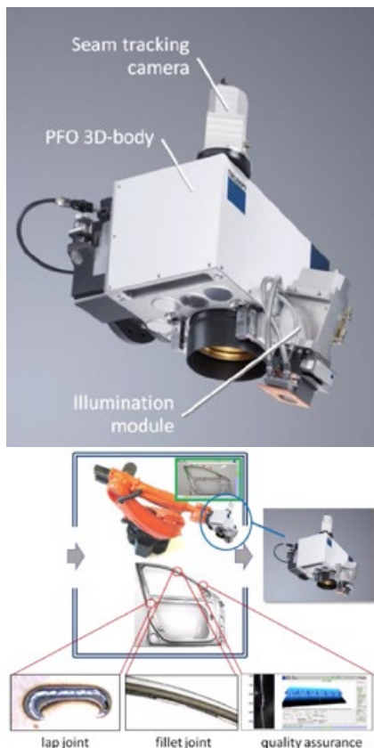
Figur 18. Trumpf har ju förutom olika typer av laserkällor ett antal laserverktyg i sin produktportfölj. En ny variant är I-PFO med vars hjälp man kan utföra såväl överlapps- som kantsvetsar, det senare med hjälp av en innovativ fogföljningsprincip.
