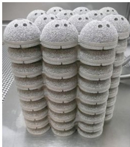
Figur 28. Arcams EBM-teknik ger möjlighet att stapla komponenter på varandra under byggnationen. Detta ger att man kan använda byggvolymen maximalt, vilket ger hög produktivitet.
