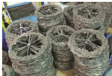
Figur 3. Ett antal laserskurna bromsskivor i väntan på avslutande finisharbete.
