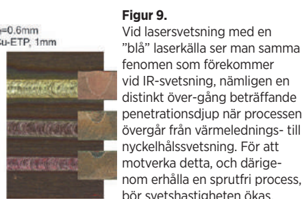
Figur 8. Överlappssvetsning av två 0,5 mm tjocka kopparmembran med "blått" laserljus ger vid handen att förhållandevis stora spalter kan överbryggas; fr. v. 0,2 mm, 0,3 mm och 0,5 mm. I det senare fallet kunde emellertid endast 70% av svetslängden uppfylla ställda kvalitetskrav.
