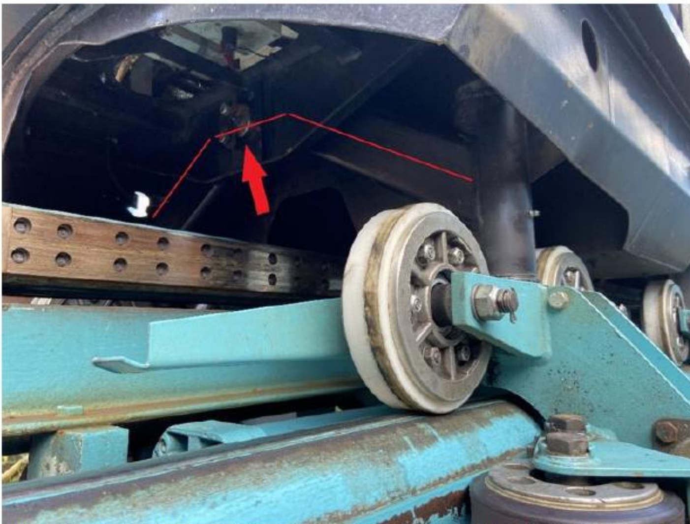
Figur 3. Undersidan på den främsta vagnen i ett av tågen med den främre rörliga bärarmen markerad med rött streck. Den röda pilen pekar mot änden på den axel där bärarmen var monterad. (Bilderna är inte från olyckståget).
