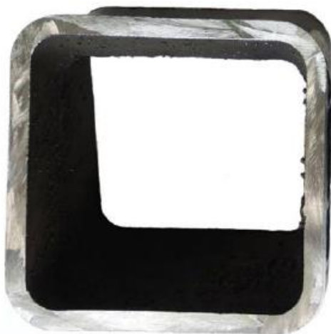
Figur 18. Tvärsnitt av två uppsågade bäramar. Ursprunglig bärmarm tillverkad 1986/87 till höger och tillverkad 2019 till vänster. Bild: Element Materials Technology AB.
