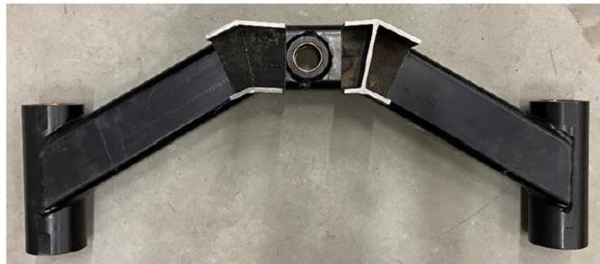
Figur 19. Bilden visar en bärmarm med utsågade prover lagda ovanpå. Provet till vänster är från en bärmarm tillverkad 2019 och till höger från en ursprunglig bärmarm. Den tvärsållda plåten som saknas i den vänstra syns i den högra delen.
