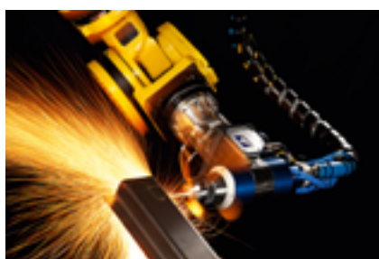
Figur 1. Industriell 3D-laserskärning ökar stadigt bl.a. genom ökad användning av presshårdade detaljer till fordonsindustrin, vilka ofta kräver håltagning och renskärning. Precitec SolidCutter är ett välbeprövat skärhuvud för laserskärning med robot.
