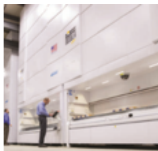
Figur 5. Modulas vertikala lagerhissystem, vilket tillverkas i USA, används som lagerlösning för många industriprodukter, komponenter och reservdelar inom flera olika branscher.
