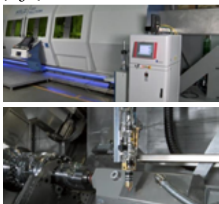
Figur 9. I denna kombinationsmaskin från WFL Millturn Technologies kan man både fräsa, svetsa, härda och tillverka med additiv teknik.
