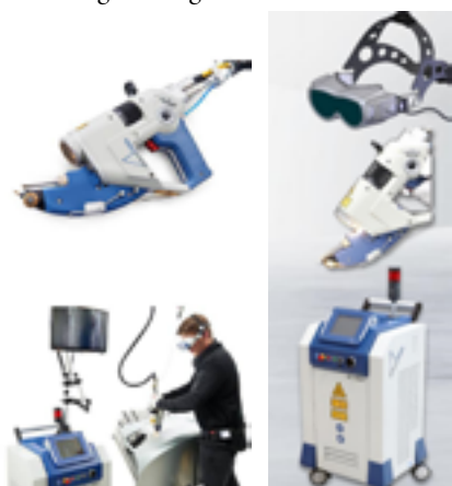
Figur 20. Med ett handhållet verktyg från AlphaLaser kan BMW idag reparera svetsar och lödfogar på påhångsdetaljer. Laserkällan har 450 W medeleffekt och i utrustningen ingår speciella säkerhetsglasögon vilka ger en förstörd bild över arbetsområdet.
