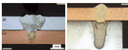
Figur 9. Vid överlappssvetsning av tunna aluminium och kopparfolier undviker man uppblandning av materialen i svetsgodset då aluminiumfolien är placerad överst. Vid det omvända förhållandet bör aluminiumpartnern väljas tjockare för att undvika full penetration och att därmed en större turbulens uppstår i svetssmältan.
