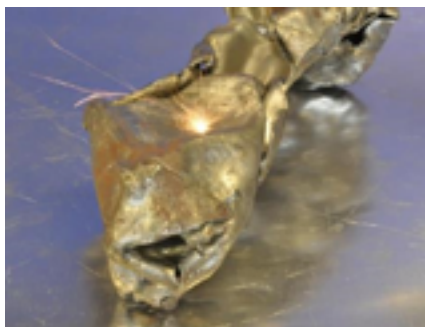
Figur 30. Ovan principen för LIBS med vars hjälp man förågrar det yttersta atomlagret på skrotdetaljen och skapar ett plasma, vars våglängdsspektrum kan analyseras och bestämma aluminium-materialelets legeringstyp.
