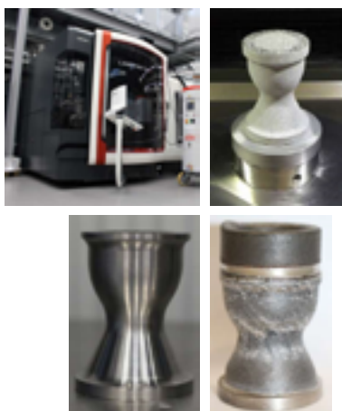
Figur 7. I en kombinationsmaskin från företaget Lasertec har man vid IWS byggt upp vidstående förbrännarenhet med LMD, vars yta därpå slipats för att ge ett bra underlag för den därpå följande LMD-beläggningen med olika, prestandahöjande material.
