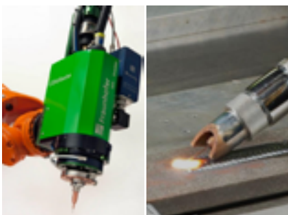
Figur 19. Tidigare har man tvingats välja stickande eller släpande trådmateriäl beroende på aktuell applikation, men idag finns det verktyg på marknaden med koaxiell trådmateriäl vilket skapar en helt annan flexibilitet då det gäller 3D-printning med tråd.
