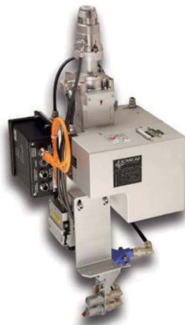
Figur 3: Ett av IWS speciellt utvecklat verktyg för att undvika höga temperaturgradienter och därmed uppkomsten av intermetalliska faser vid lasersvetsning av aluminium till koppar. Verktöget kan oscillera laserstrålen i x/y-planet med 2 kHz frekvens och arbetar med en fokallängd på 245 mm. Det är dimensionerat för lasereffekter upp till 4 kW och har ett arbetsområde på 10×10 mm.
