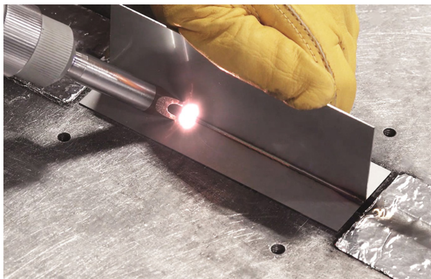
Figur 3: Ett fint resultat kan uppnås med lasersvetsen.
