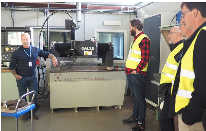
Mattias Weibull presenterade Höganäs ArcX vattenskrämaskin som används för att kapa belagda prover utan värmepåverkan.
