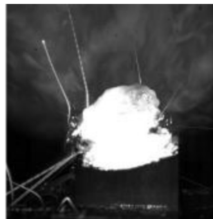
Figur 11: Vänster: Det finns många sprutsvetsar Höger: Den optimerade strålen minskar stänket avsevärt.
