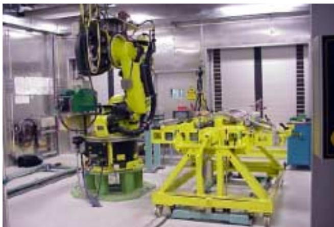
Figur 11. Inblick i DaimlerChyslers lasersvetscell för sammansättning av aluminiumsidodörrarna till lyxmodellen Maybach.
