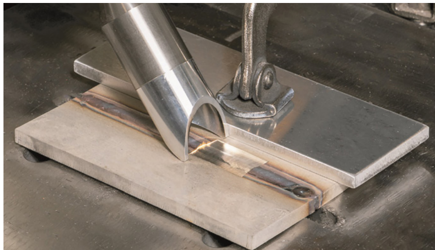
Figur 4: Med cleaningsmunstycket kan fogen eller materialet rengöras.
