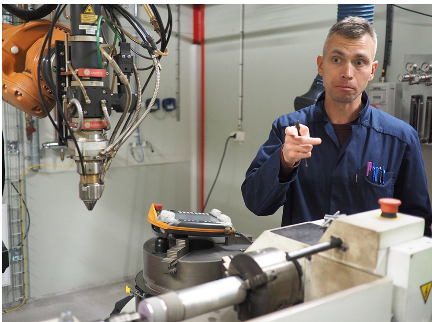
Ivan Smirnov demonstrerade Höganäs ArcX utrustning och process för höghastighetslaserpåsvetsning.
