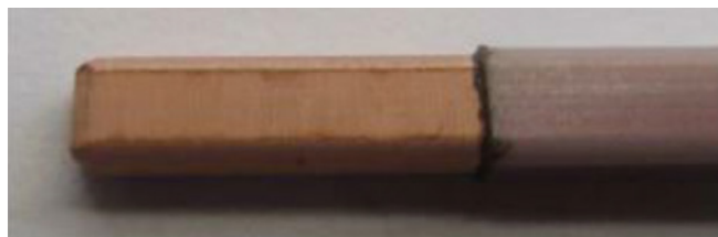
Figur 7: Ablation med TruMark 7050 på en platt koppartråd belagd med PEEK. Karboniseringseffekten är synlig vid kanterna.
