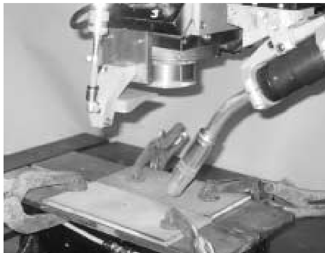
Figur 1. Försökupställning för plana provbitar
