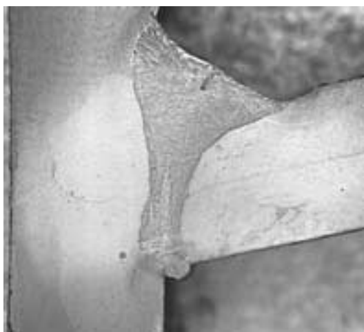
Figur 2 b. Käl-fog, klippt kant, 8 mm, 77° fogvinkel. 6 kW, v=0,7 m/min, trådmatt=13m/min
