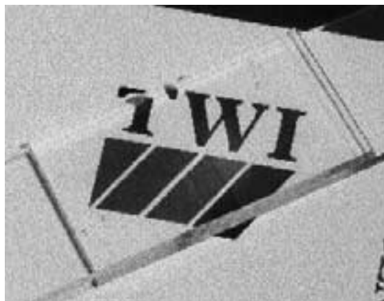
Figur 17. ClearWeld – tekniken applicerad på två genomskinliga PMMA-plattor.
