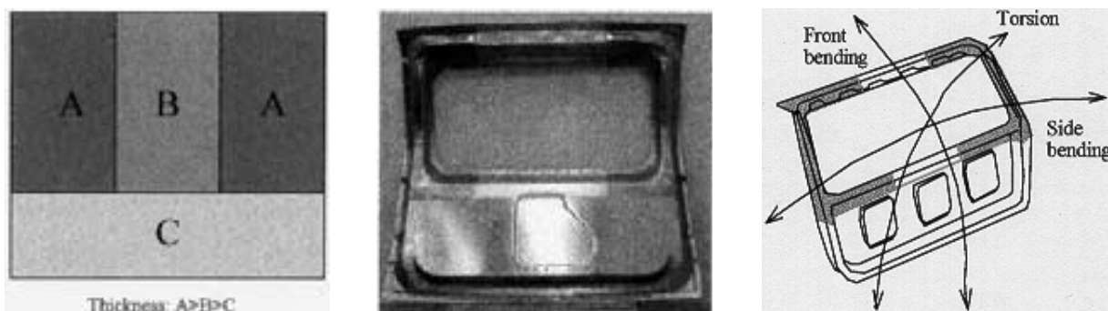
Figur 8. Bakdörrspanel i aluminium, ämnesskarvad av fyra olika plåtämnen.
