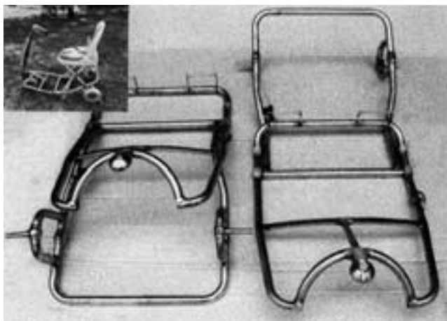
Figur 23. Hopfällbar handikapp-scooter som idag TIG-svetsas, men där lasersvetsning övervägs som framtida hopfogningsmetod.
