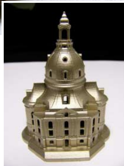
Figur 22. En synnerligen intressant teknik – lasersintring. Här ses några exempel: Överst "romboïda bollar" med en diameter på 50 mm, och därunder en 7 cm hög modell av "Frauenkirche" i Dresden.
