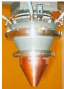
Figur 15. Ovan strålanalysen av en 3 mm (a) resp. 6 mm (b) fokalpunkt. T.h. det av Precitec utvecklade munstycket för laserpåläggning.
