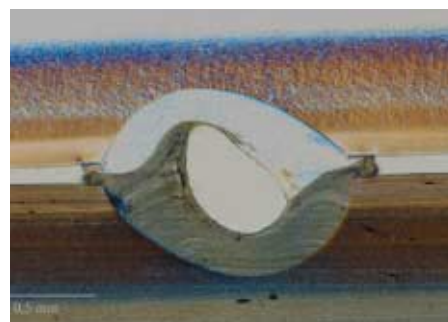
Figur 14. Diagrammet illustrerar den överlägsna spaltöverbrygnadsförmågan vid kvasi-simultan svetsning jämfört med kontursvetsning. Den vänstra och mittersta tvärsnittsbilden visar överlappssvetsar vid nollspalt och olika infärgning med kol: 1.0 resp. 0.1 vikts-%, svetsade med 2 m/min. Längst t.h. 0.12 mm spalt, 0.5 % kolhalt och en svets hastighet på 4m/min; inget särskilt snyggt svets tvärsnitt, men dock en acceptabel hållfasthet.
