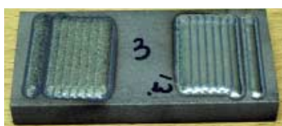
Figur 16. Ytkvalitén vid laserpåläggning med grövre korn (t.v.) och med finare kornstorlek (t.h.).
