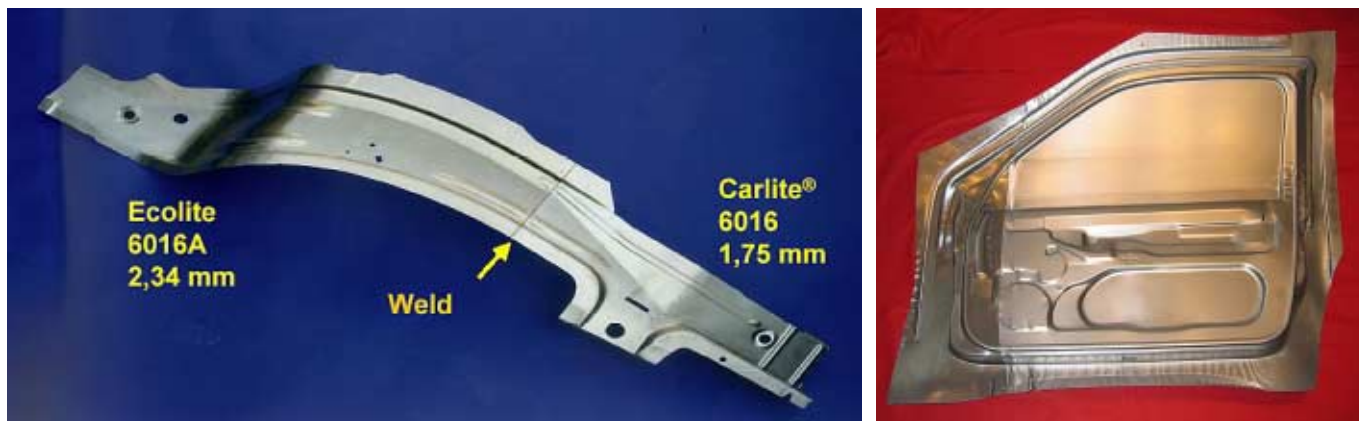
Figur 6. Exempel på tidiga applikationsförsök för ämnesskarvning av aluminium; t.v. främre sidobalk (Volvo 850) och t.h. sidodörr, inre (VW Lupo 3-L).
