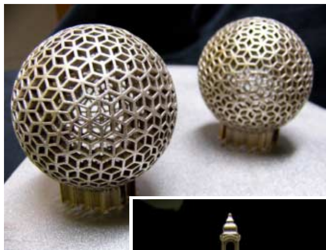
Figur 22. En synnerligen intressant teknik – lasersintring. Här ses några exempel: Överst "romboïda bollar" med en diameter på 50 mm, och därunder en 7 cm hög modell av "Frauenkirche" i Dresden.
