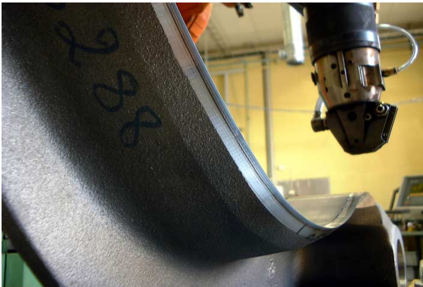
Lasertech arbetar bland annat med laserytbehandling. Här trimmas robotbanan för en komponent inför laserhårdning.
