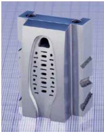
Figur 3. Ett form- verktyg skapat genom laserformning eller DPMD (Direct Powder Metal Deposition).
