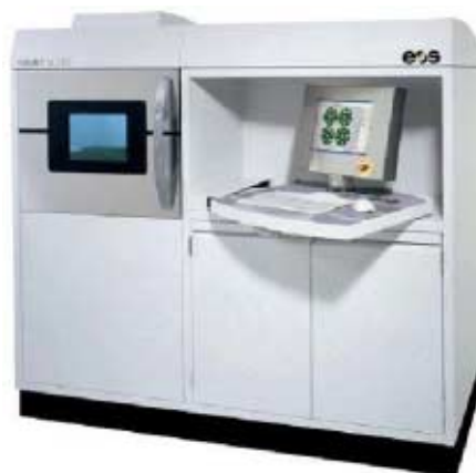
Figur 21. Företaget EOS senaste maskin för DMLS (Direct Metal Laser Sintering); EOSINT M270.
