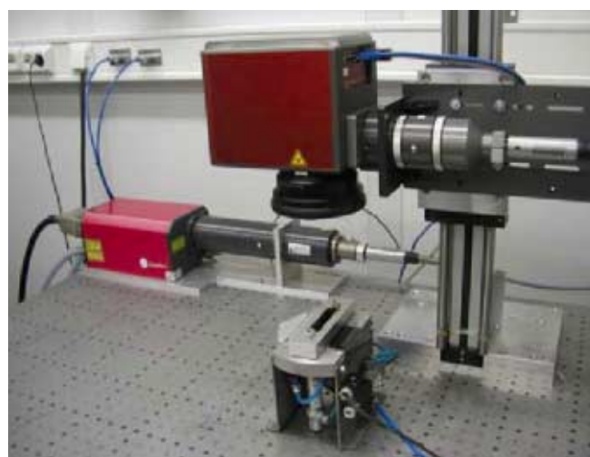
Figur 13. Principen för kvasi-simultan lasersvetsning av polymerer. Ovan den försöksuppställning som använts vid Universitetet i Lappeenranta, en LaserLine LDF 400-200 DioScan F som är fiberkopplad till ett "scannerhuvud".
