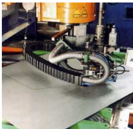
Figur 3. Tillverkning av icke-linjära tailored blanks hos Thyssen Platinen Werk i Hüttenheim.
