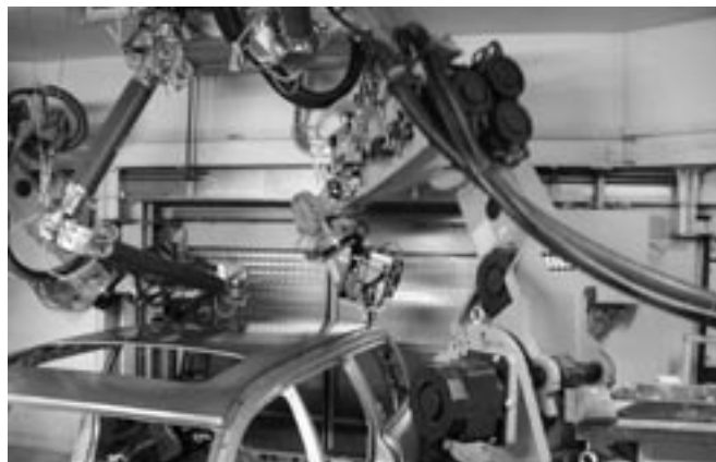
Figur 3. Lasercellen för takskarvssvetsning av Volvo V70 och S80-modellerna, där man nyligen ersatt en "uttjänt" CO 2 -laser med en 4kW Nd:YAG-laser (till höger).
