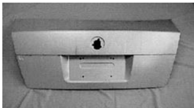
Figur 4. Laserlödning av bakluckan till VW-modellen Bora, med lödfogen placerad mellan ovan- och underdel (se komplett sammansatt lucka, underst).
