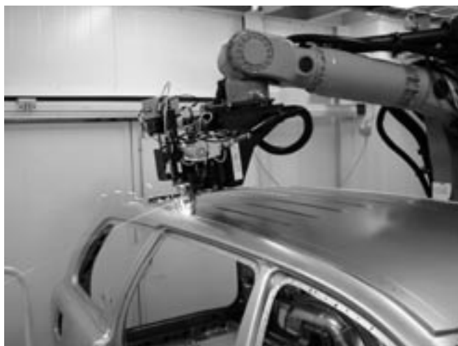
Figur 2. Takskarvssvetsning i den nyinstallerade lasercellen på VCT (Volvo Cars Torslanda) för tillverkning av Sport Utility-modellen (SUV) Volvo XC90.
