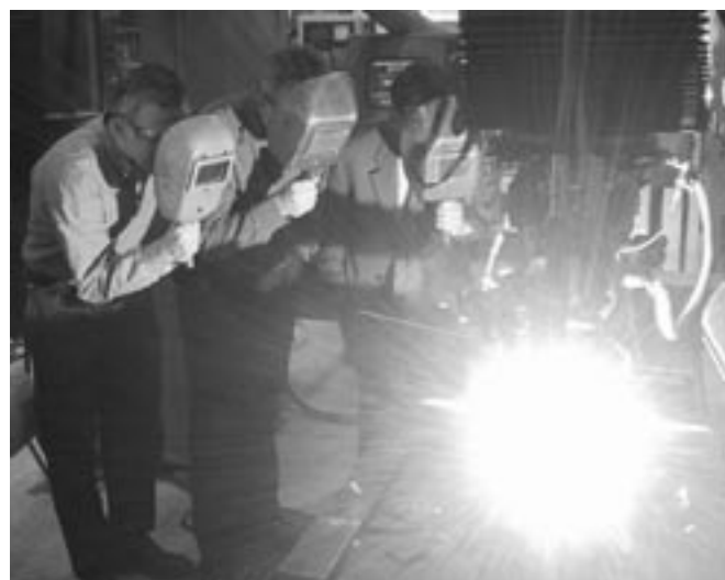
Figur 8. Laserhybridsvetsning kombinerar en traditionell bågsvetsning med MIG/MAG med lasersvetsning i en helt ny process med stor potential för framtiden. Metoden gör det möjligt att svetsa med hög svets hastighet och liten värmetillförsel trots stora spalter i både tunt och tjockt material.
