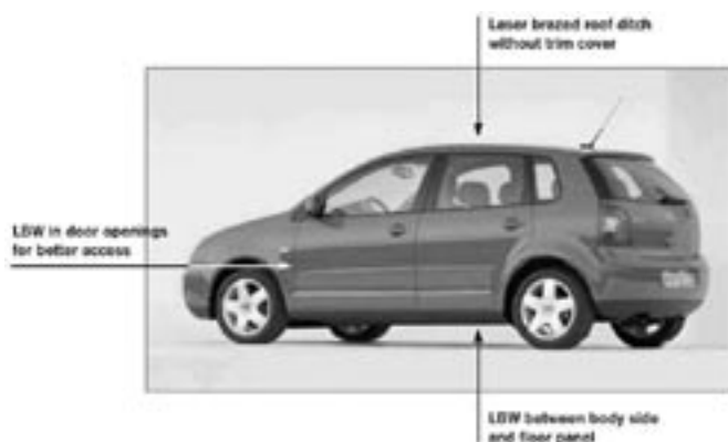
Figur 9. Laserapplikationer på nya VW Polo, med bl.a. laserlödning av taket, vilket är första gången som denna metod används för strukturbärande detaljer.
