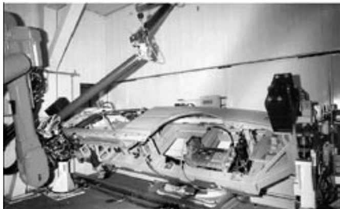
Figur 5. Produktionscellen i BMWs fabrik i Regensburg för lasersvetsning av karossida, komplett för 3-seriens cabrioletversion.
