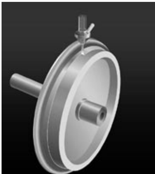
Figur 6. Laserpåsvetsning av järnväghjul sker med superlegeringar med tjocklekar på 2-5 mm. Hjulmaterialet för ett elastiskt uppträdande som inte ger sprickor. Hjulen blir runda och tysta och får lång livslängd, och de sliter dessutom mindre på rälsen.
