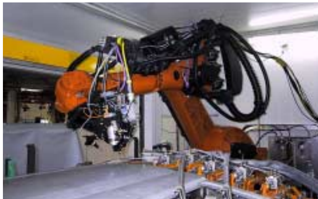
Figur 8. Bild från applikation med kombinationsverktyg för lasersvetsning/lödning med Kuka-robot.
