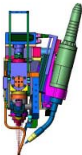
Figur 5. Verktöget förberett för svetsning. Trådmataren i övre läget.
