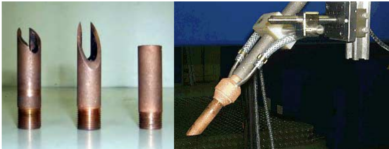
Figur 2. Lasal-munstycket ger bättre gasskydd och därmed mindre oxidering av svetsen.
