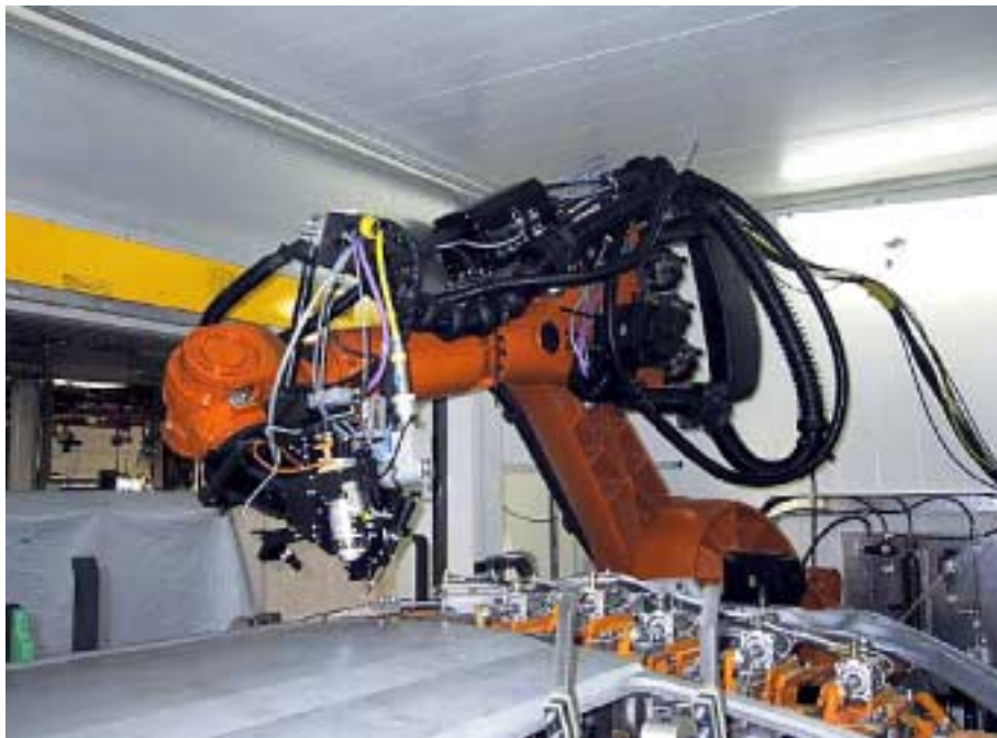
Figur 7. Kombinerad lasersvetsning/laserlödning av karossidor i VWs Poznan-anläggning.
