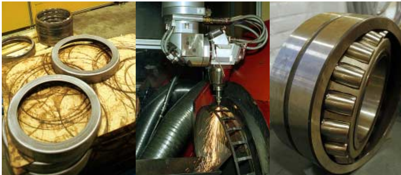
Från ax till limpa. Från ämne via laserskärning till det färdiga lagret för att hålla de sfäriska rullarna på plats.
