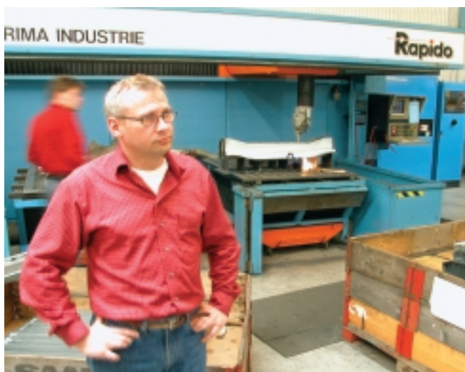
Gert Guldbrand visar en Prima Rapido för 3D-skärning, en av trotjänarna vid företaget.
