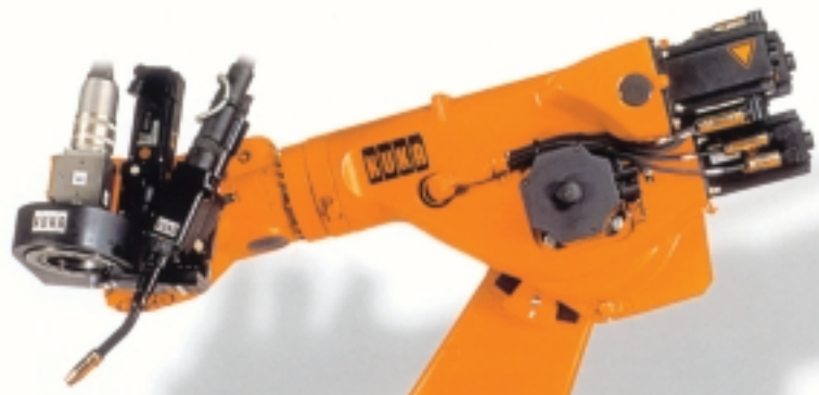
KUKA hybridsvetshuvud har en egen programmerbar axel som gör det möjligt att rotera svetspistolen runt laserstrålen
