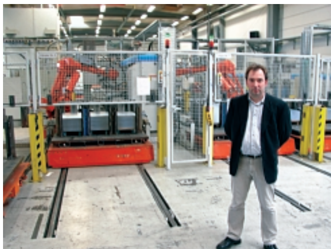
Fredrik Thyr visar robotinmatningen av ämnena i tailored blanks anläggningen.
