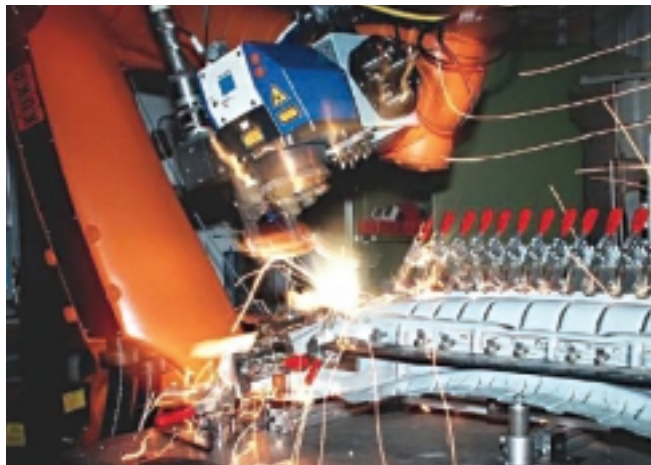
Figur 8. Intressant remote-lösning hos DaimlerChrysler i Sindelfingen; Bakstycket ("Heckmittelstück") till senaste S-Klasse modellen.
