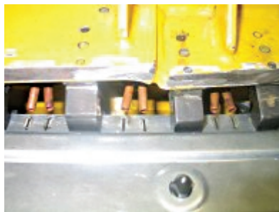
Figur 11. Detalj som visar den i fixturen integrerade skyddsgastillförseln; ett utloppsmunestycke per stegsvets.
