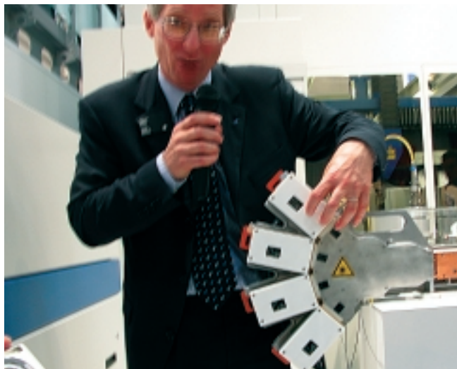
Byte av laserdiodpaketen går snabbt och enkelt, visar Hubert Wilbs.
