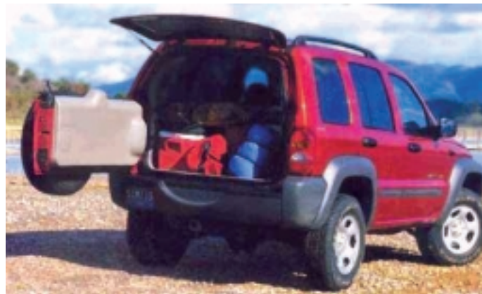
Figur 7. Bilvärldens första applikation för "remote laser welding" – bakkörren till Chrysler Jeep Liberty. Produktionen påbörjades i Sterling Heights' pressverk 2001 och för installationen (t.v.) svarade Utica Inc.
