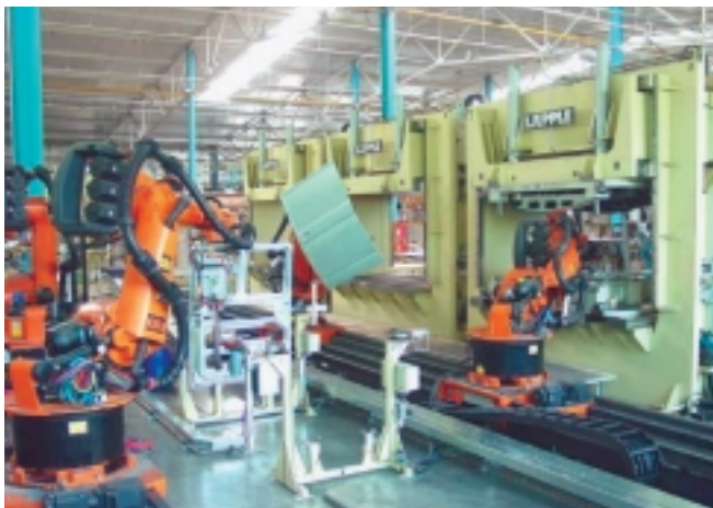
Figur 14. Interiörbilder från Teublitz-fabriken för volymproduktion av skjutdörrar till transportfordon. En 4 kW laserälla används för remote-svetsning och cykeltiden ligger på 120 sekunder per dörr.
