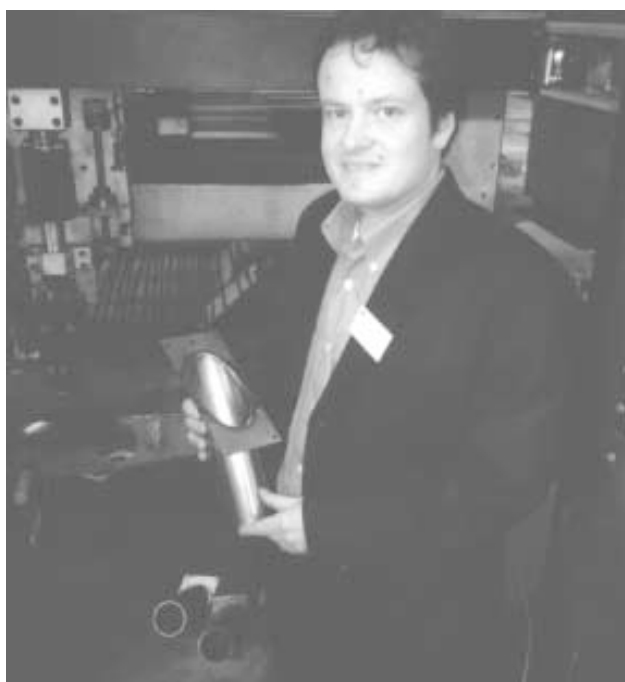
Bild 5. Bengt Johansson visar en småländsk "innovation" – en rörstos "brutalsvetsad" med laser. Då kan större spalter än vad som är vanligt överbryggas.
