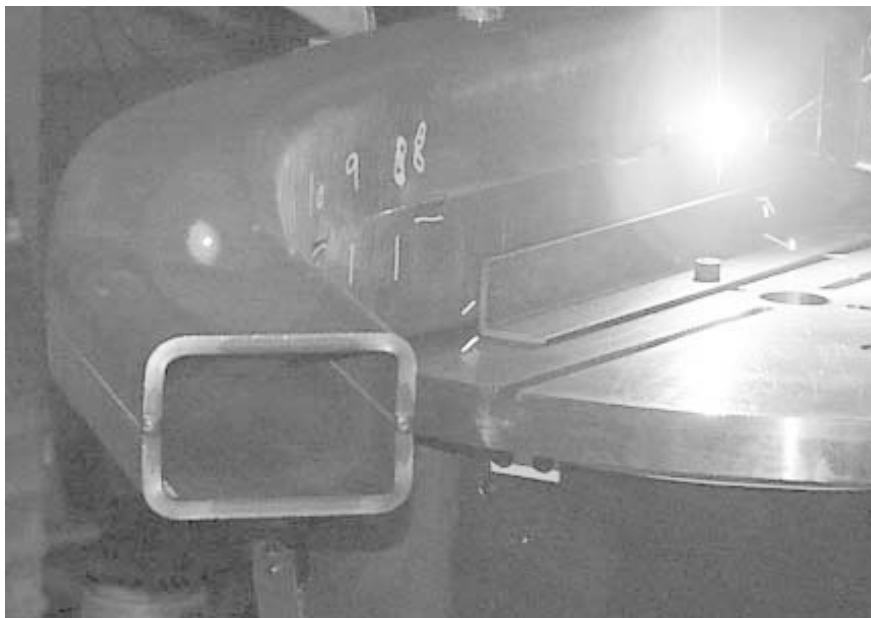
Bild 1. Lasersvetsning av "bananbalk" som tillverkas av 9 mm Domex-material. Svetstid ca 2 min. med 17 kW CO 2 -laser. Balken sitter i bakhjulsupphängningen i Scania-bussar.
