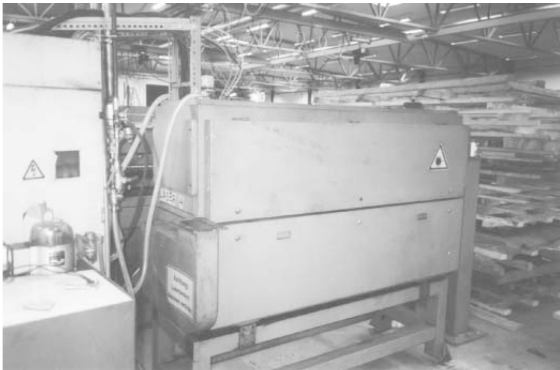
Bild 6. En trotjänare som fortfarande gör sitt jobb. Lasern, en Rofin Sinar 1500W har tidigare använts för svetsning av ventilttryckare hos Volkswagen i Tyskland.
