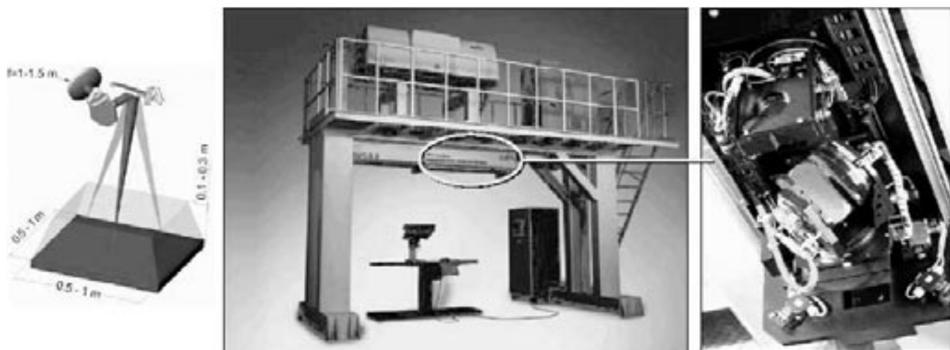
Figur 3. Principen för Remote Welding och ett svetssystem utvecklat av Rofin Sinar, Hamburg.
