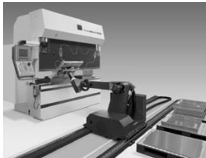
Figur 3. Trumpf BendMaster är ekonomisk även vid små seriestorlekar tack vare kort programmerings- och ställtid.
