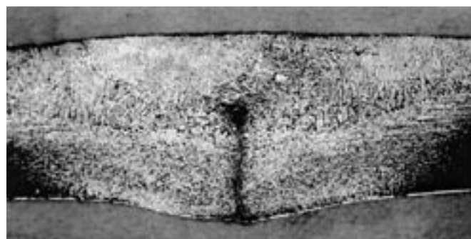
Figur 3. Svetsdefekter orsakade av oxidinneslutningar
