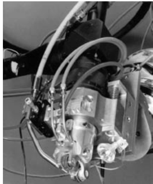
Figur 8. Ett speciellt utvecklat processhuvud för svetsning av artolika materialkombinationer
