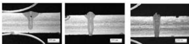
Fokusdjup vid svetsning, kontinuerligt respektive supermodulerat (pulsat), i rostfri 304 plåt
