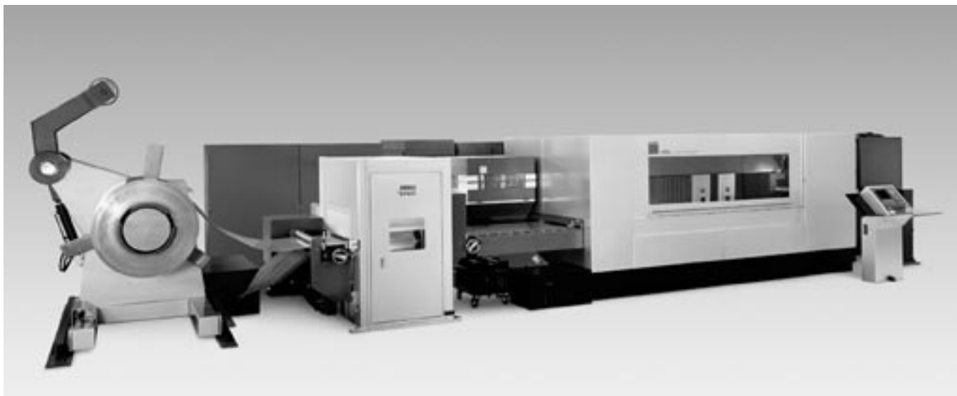
Figur 1. Trumpf Trumatic HSL 2502 C skär tunnplåt direkt från coils med två lasrar.
