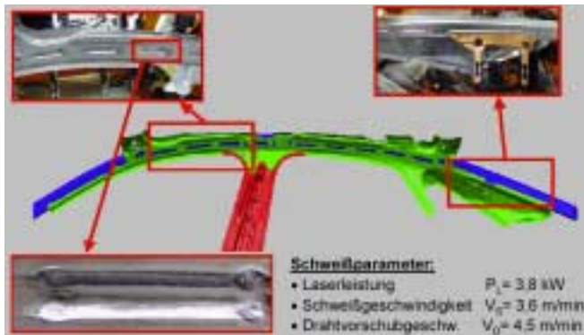
Figur 12. Den extremt släta svetsrågen på Audi A8's taksvällare åstadkommen genom användning av laserhybridsvetsning. Följande processparametrar används: laser effekt 3.8kW, svetshastighet 3.6m/min, trådmatningshastighet 4.5m/min.
