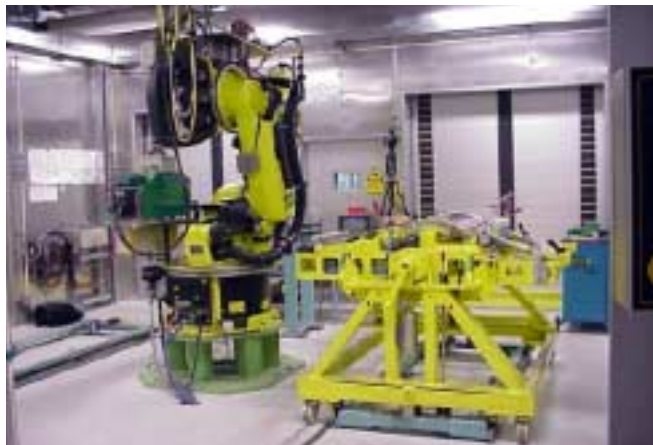
Figur 11. Inblick i DaimlerChryslers lasersvetscell för sammansättning av aluminiumsidodörrarna till lyxmodellen Maybach.
