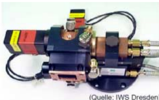
Figur 10. Olika scanner-optik-system som används vid svetsning av avgaskylare hos Behr GmbH; system Scanlab t.v. och system IWS Dresden t.h.
