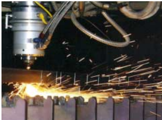
LASOX- tekniken oppges kunna skära 50 mm stålplåt med 12 m/min.
