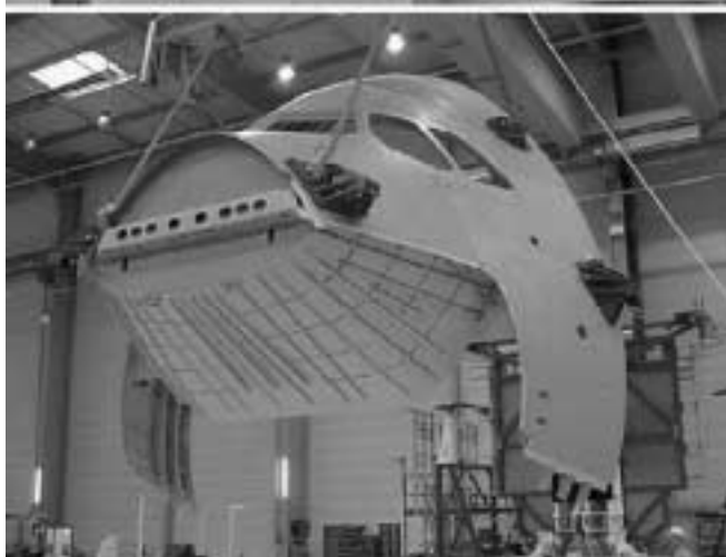
Nästa laserutmaning hos AIRBUS; svetsning av förstärkningsribbor på dubbelkrökta ytor för skrovet till militärflygplanet A400M.
