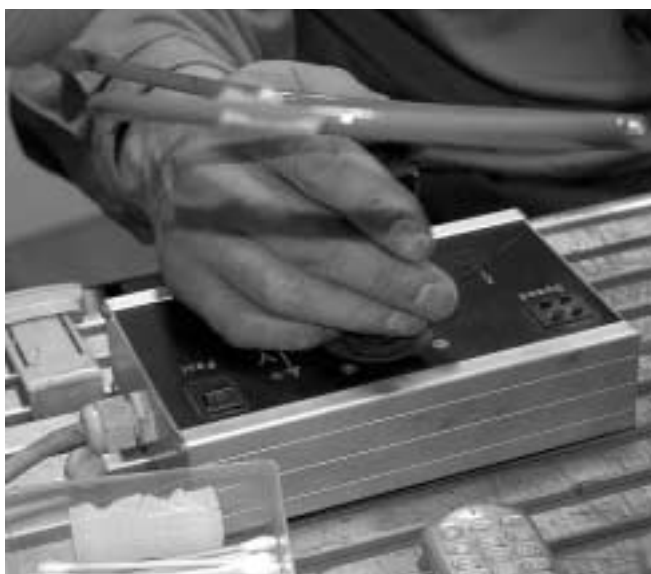
Joysticken, som styr axlarna till lasersvetsen.
