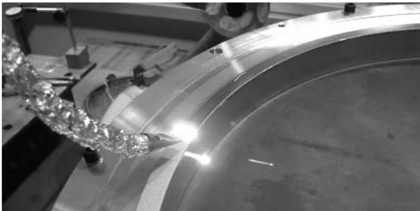
Ytomsmältning av plasmasprutade skikt vid FORCE Technology.
