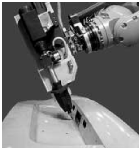
Laserlödning av bakdörren på Mercedes nya E-klass' herrgårdsvagn.
