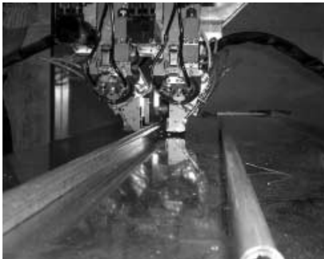
Svetsning av förstärkningsribbor till aluminiumpaneler avsedda för flygplanskroppen till AIRBUS 380. Svetsningen sker med hjälp av två stycken 4 kW Nd:YAG-lasrar och ett speciellt svetshuvud som medger parallellsvetsning av ribbornas båda sidor. Ett tvärsnitt genom en dylik svets ses ovan till höger.
