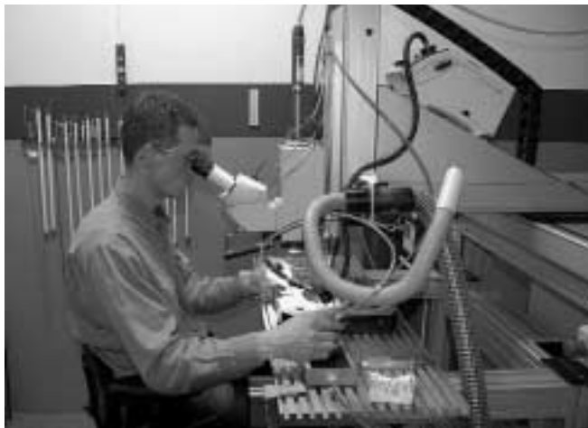
Johan Kraft vid lasersvetsen. I vänsterhanden tillsatsämnet, högerhanden på joysticken och foten på pedalen som styr laserljuset.
