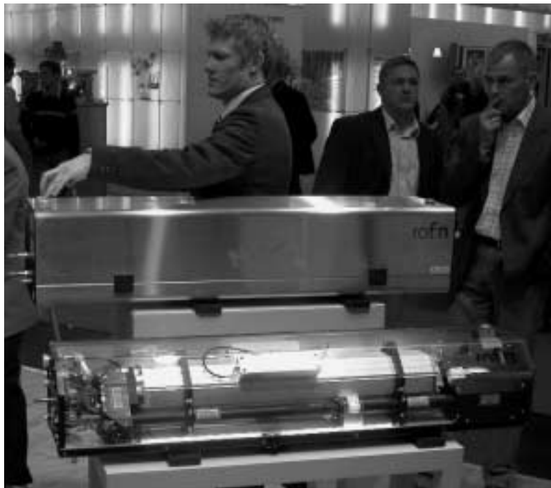
Rofin SC x 60 är en diffusionskyld, försluten CO 2 -laser för skärning av papper, trä, plast keramik, glas och tunn metall.
