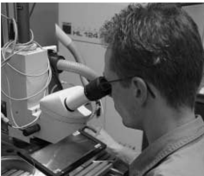
Lasern som ACRON använder är en TRUMPF HL 124 med en effekt av 120 watt. Ljuset transpiteras i den gula ledningen.
