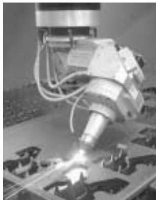
Fogberedning av tjock plåt med Prima Domino.
