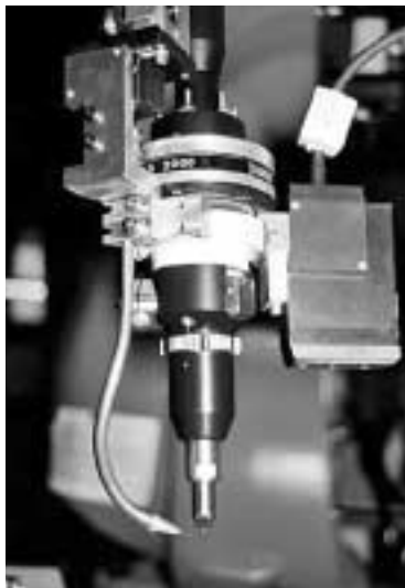
Ett Plasmatron®-svetshuvud som till sin kompakthet väl kan matcha motsvarande laser-verktyg.
