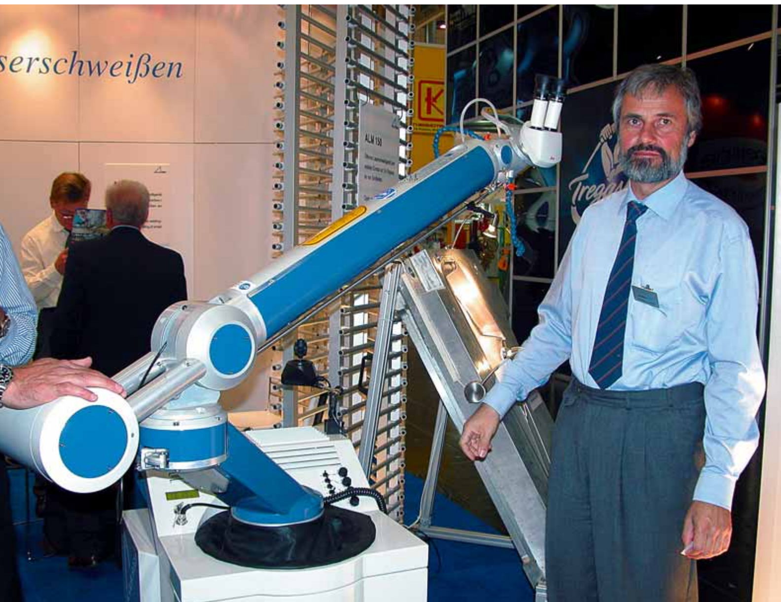
Wolfgang Seifert, vd vid Alpha Laser visar företagets nya mobila laser för reparationssvetsning av t.ex. verktyg.
