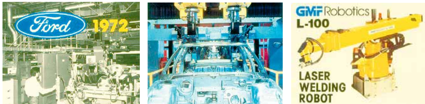
Figur 6. Några exempel på tidiga misslyckanden med laserteknik inom amerikansk bilindustri. Från vänster Fords högeffekts CO 2 -laser för svetsning av kompletta karossgolv, den första tredimensionella lasersvetsningen inom bilvärlden: Chevrolet Corsicas takskarv samt Fanucs idé med robotmanipulerad CO 2 -lasersvetsning.
