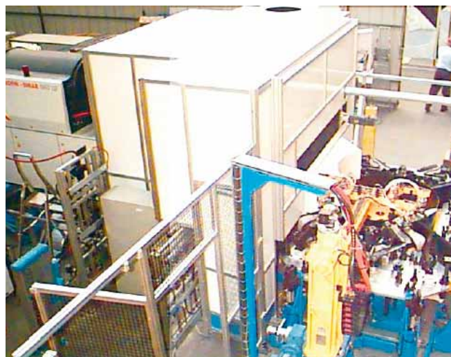
Figur 3. Lasersvetsning av en justermekanism åt Renault. Närmast ett detaljutsnitt över svetsområdet och t.h. produktionscellen hos PCI.
