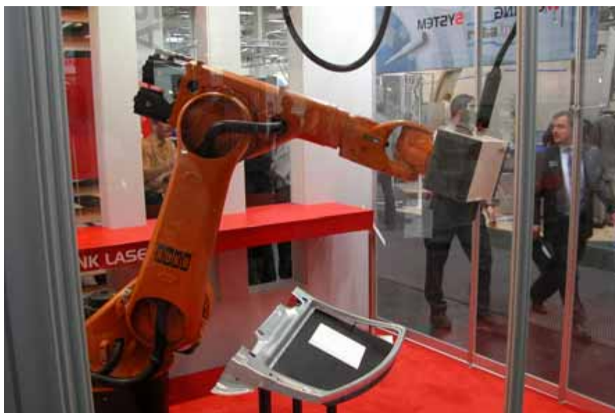
Rofin's scanner-svetshuvud, SWS, med industrirobot kan ersätta punktsvetsning inom t.ex. bilindustrin.
