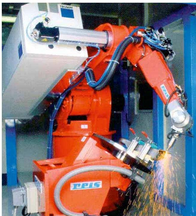
Reis robot för svetsning och skärning med inbyggd strålgång, här med Trumpf 2 kW TCF-laser
