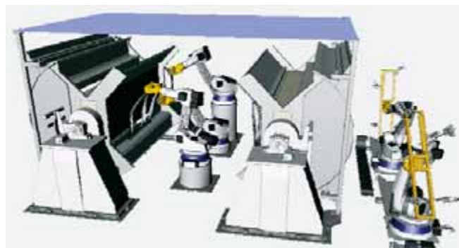
Figur 3. Animation av en lasersvetscell för tillverkning av t.ex. karossidor. Högerdetaljerna laddas samtidigt som svetsning sker av vänstersidan, vilket ger ett optimalt utnyttjande av laserkällan.
