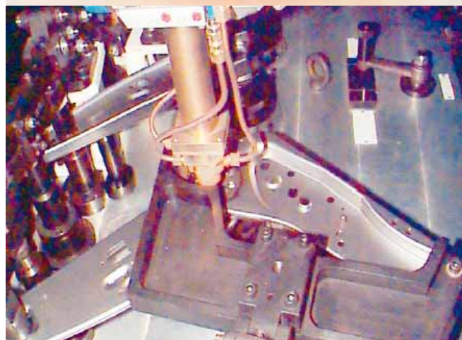
Figur 3. Lasersvetsning av en justermekanism åt Renault. Närmast ett detaljutsnitt över svetsområdet och t.h. produktionscellen hos PCI.
