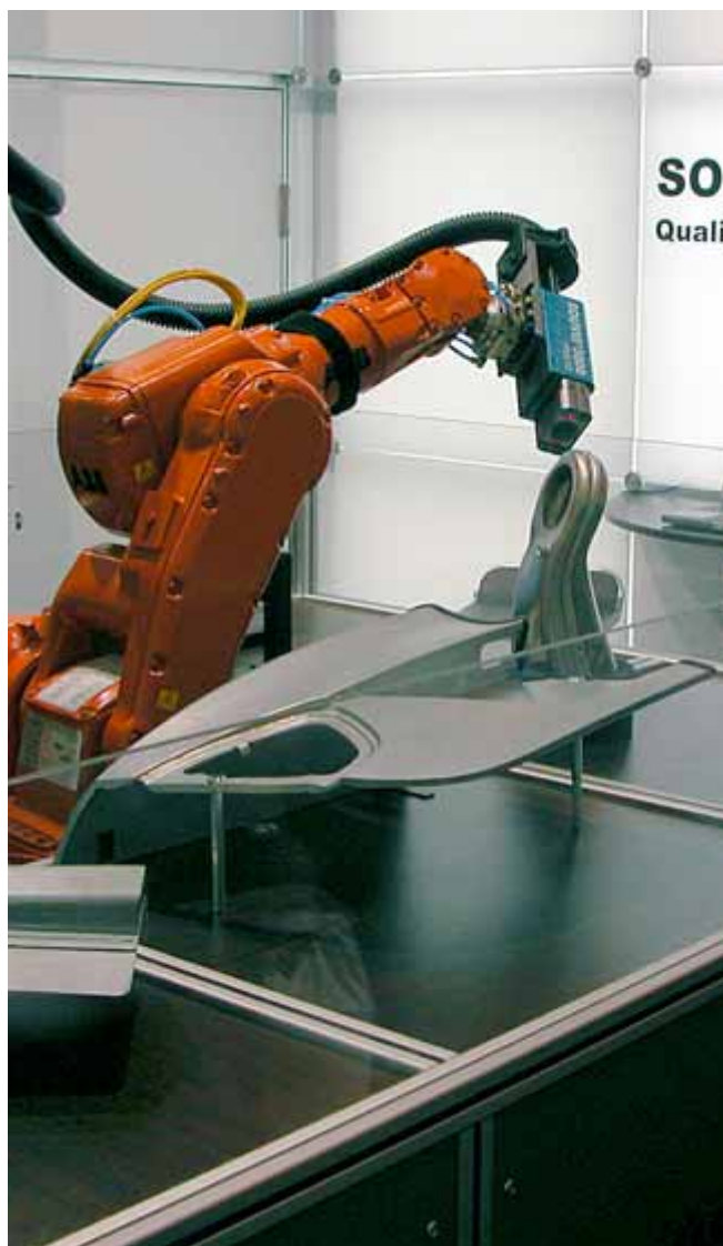
Souvis 500 är ett kamerabaserat system från Soudronic Automotive för att kontrollera ytkvaliteten hos lasersvetsade och laserlödda fogar
