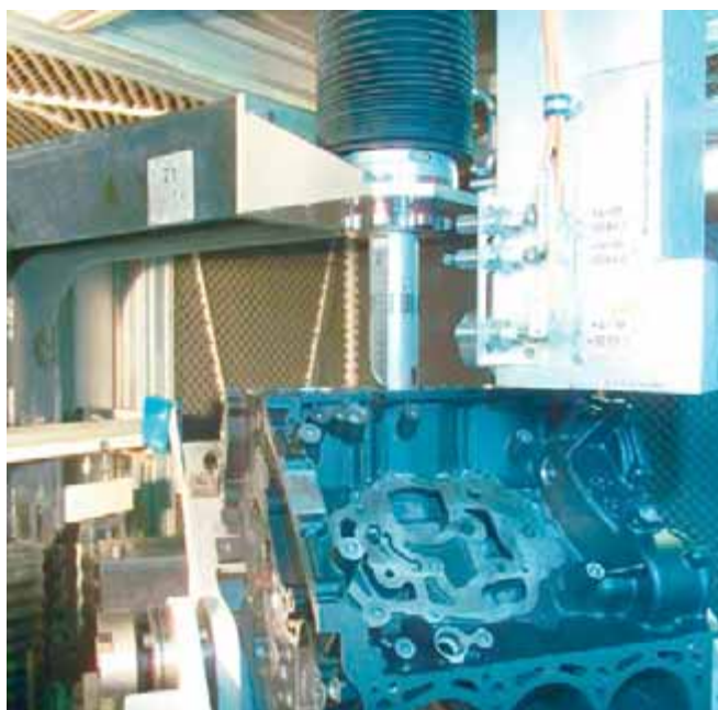
Figur 1. Ytmodifiering av cylinderväggarna på Audis gråjärnsmotorblock med hjälp av en 300 W UV-laser
