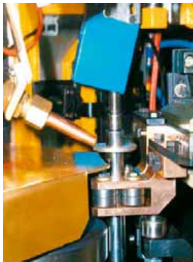
Figur 4. T.v. lasersvetsning av stötdämparstänger åt PSA Citroën och t.h. en översiktsbild av svetshuvudet.
