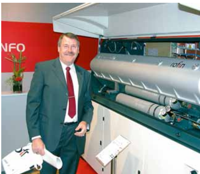
Pierre Scheyvaerts, Rofin Sinar, visar den nya 8 kW slablasern, DC080 W Compact som har en strålkvalitet på K > 0.9 .
