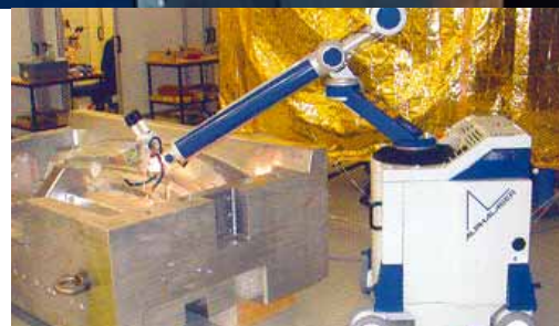
Wolfgang Seifert, vd vid Alpha Laser visar företagets nya mobila laser för reparationssvetsning av t.ex. verktyg.
