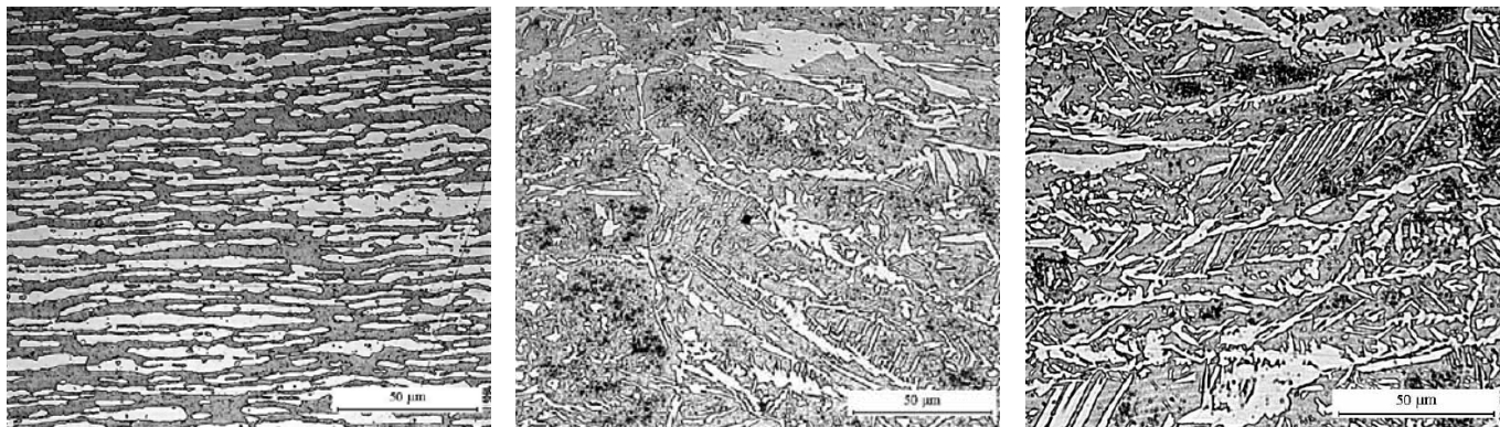
Bild 3. Till vänster strukturen i ett duplex rostfritt stål, i mitten ett autogent lasersvetsat (dvs utan tillsatsmaterial) svetsgods och till höger svetsen efterbehandlad med laser. Utgångsstrukturen har nära 50% ferrit, i svetsat tillstånd 65% och efter värmebehandling 52%.
