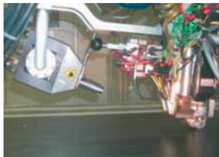
Figur 12. T.v. principen för fiberlaminering med laser, och t.h. en diodlaser med integrerad IR-pyrometer placerad intill ett fiberutmatningsverktyg.
