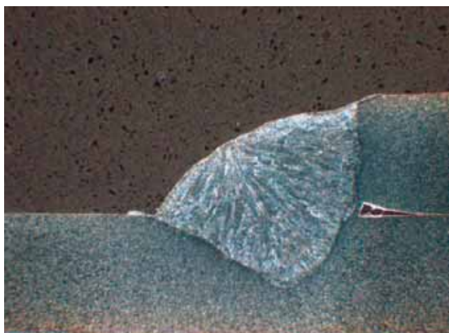
Bild 7. Till vänster Laser-MIG/MAG svetsning med släpande laser, till höger svetsning med ledande laser. Den principiella skillnaden ligger i bredd/djup förhållandet i inträngningsprofilen.
