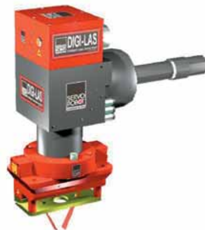
Figur 24. Servo-Robotics "Digi-Las Head" – ett svetsverktyg med inbyggd fogföljning och adaptiv kontroll av processparametrar.
