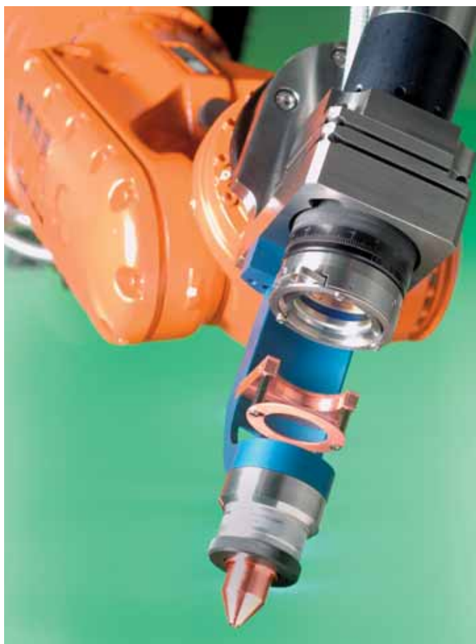
Figur 25. Dr. Petrings speciella "skötebarn", det s.k. "Kombikopf"-verktyget för flexibel laserskärning och lasersvetsning.
