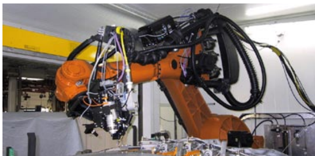
Svetsning och lödning av sidopanel VW, Poznan, 2002. Svetsning sker med fogföljning och lödning i samma verktyg vilket ger snabb omställning mellan processerna. Detta spar in en robot + cell.
