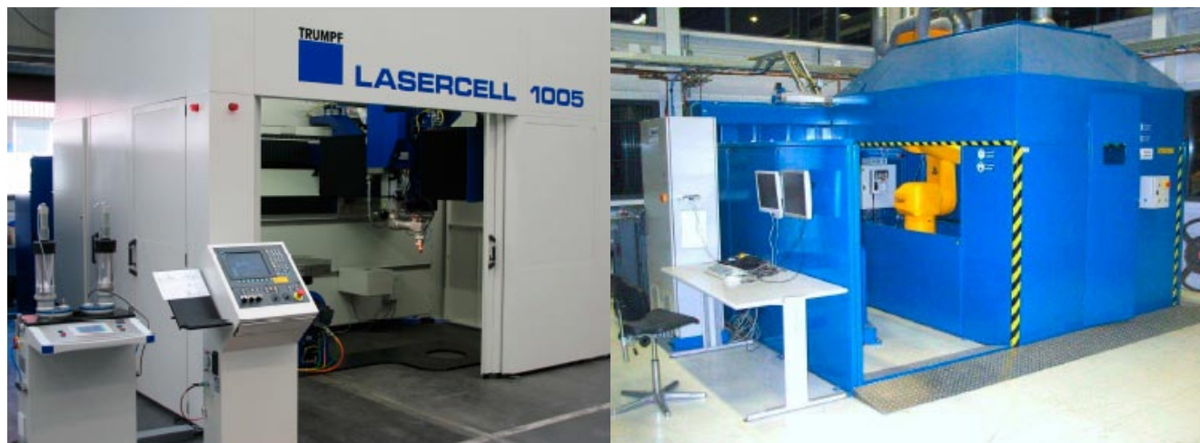
Figur 37. LMD-maskiner för reparation av flygmotorkomponenter hos Rolls Royce Aero Engines t.v. och KLM t.h.
