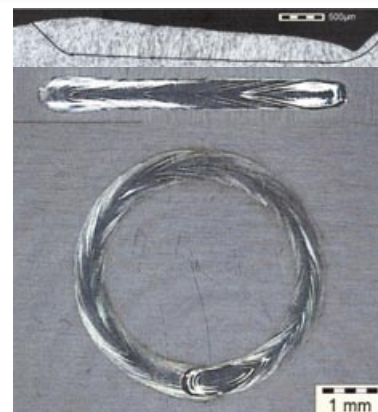
Olika metoder att svetsa en kontur med pulsad Nd:YAG-laser. Fr.v. en serie pulser med förflyttning av stråle/objekt mellan varje puls; optik som ger en ringformad stråle och "shadow-tekniken" där strålen förflyttas under pulstiden.
