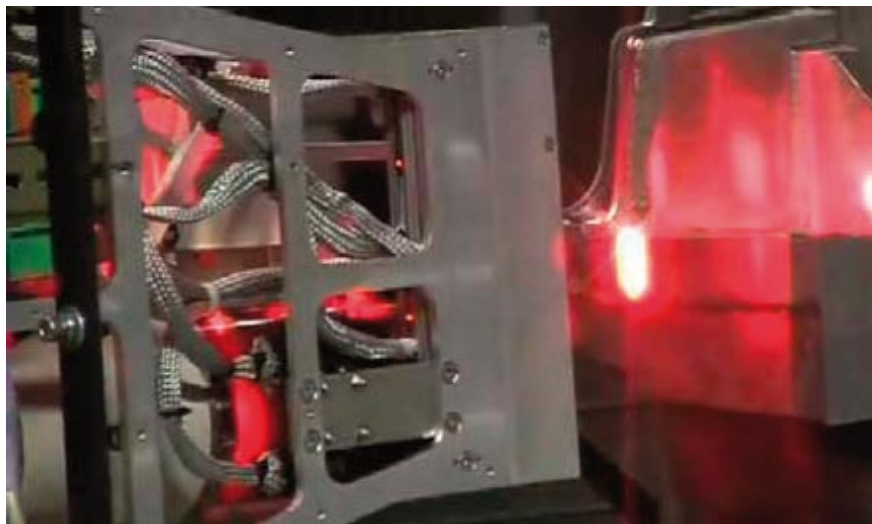
Figur 31. Laserhårdning av ett pressverktyg för en karosseridetalj. Med en "scannad" laserstråle åstadkoms 22 mm breda hårdspår.
