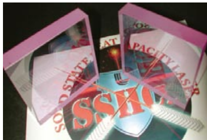
Slab variant av sintrad Nd:YAG-laserkristall. Storlek 100x100x20 mm. Används i s.k. Solid-State Heat Capacity Laser (SSHCL) utvecklade av Lawrence Livermore National Laboratory.
