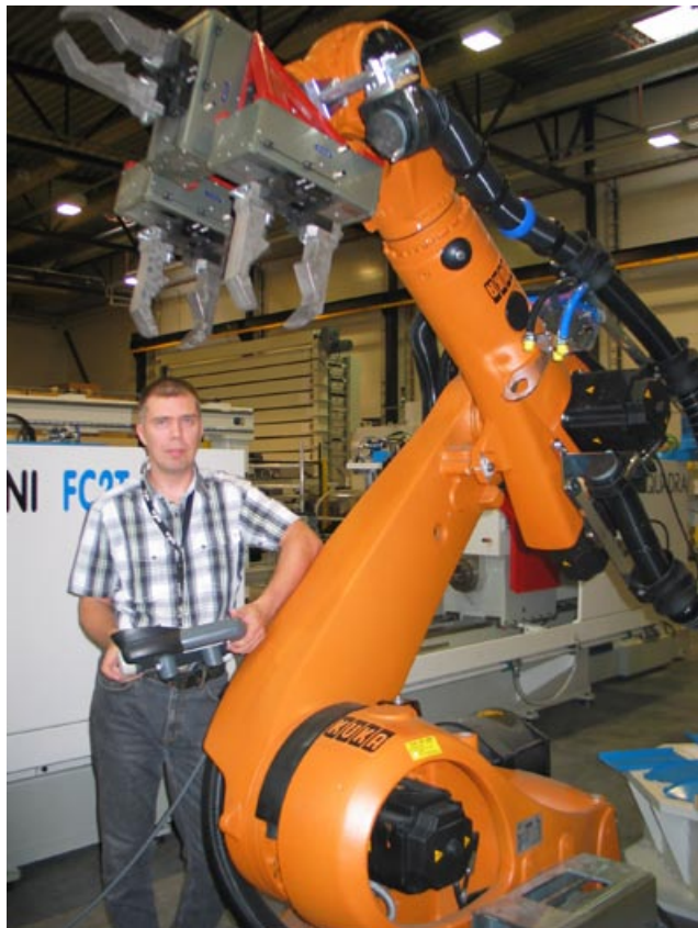
Jussi Tykkä, Laserplus robotexpert, visar en 180 kg KUKA robot som ska anslutas till ett laser-produktionssystem. Genom den mobila styrpanelen kan roboten omprogrammeras i realtid då produkt-serierna ändras.
