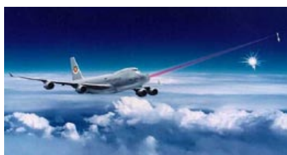
US Air Force Airborne Laser (ABL) använder en ombyggd Boeing 747 där man placerat en COIL-laser för att bekämpa missiler på flera hundra km avstånd.
