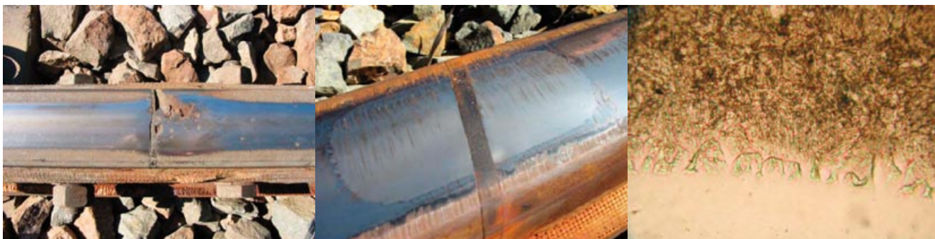
Figur 22. T.v. rälskarv på väg att falla och därpå efter reparation genom laserpåläggning medelst rostfritt martensitiskt pulver (431). Längst till höger en förstoring av smältzonen mellan det rostfria materialet och det induktionshårdade kolstålet (kolhalt 0,8%) i rälsen.
