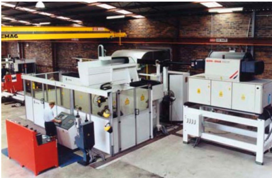
Figur 21. Utrustningen för laserpåläggning hos Jarvie Engineering Pty. Ltd.: Femaxlig portalrobot, 5 kW CO 2 -laser från RofinSinar, pulvermatare från Sulzer och styrsystem från Siemens.
