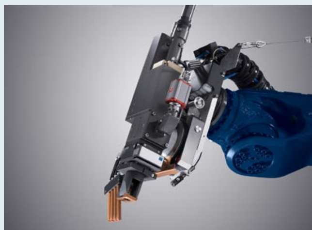
Trumpf TruLaserRobot med 3 kW disklasers är användbar för både svetsning och skärning. Foto: Trumpf
