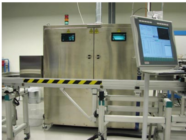
Lasersvetsstation för spridartillverkning. T.h. interiör från svetsstationen.
