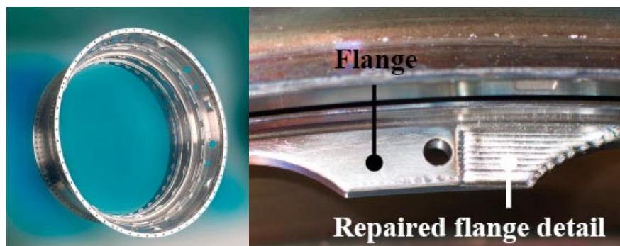
Figur 35b. Ett HPT-hus med en detalj av den reparerade flänsen t.h.
