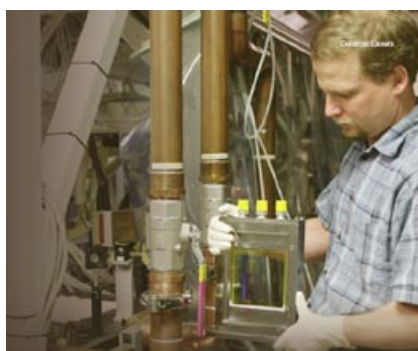
Arbete med SSHCL vid Lawrence Livermore som är den mest kraftfulla diodpumpade solid state-lasern i världen vilken ger 25 kW i upp till 10 sekunder. (Källa: S&TR, april 2006),
