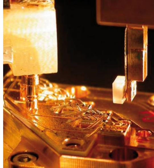
Figur 3. Här kan man tala om mikrobearbetning med laser! Montering av fokuseringslinserna på en diodlaserstav med hjälp av laserlödning där lodmaterialet tillförs som små mikrokulor.
