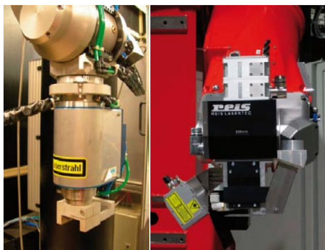
Figur 10. Spännande laserverktyg från Reis Lasertec: Närmast en i bearbetningsverktyget integrerad processövervakning (BCO) och längst t.h. en zoom-optik som kan variera fokallängden mellan 200-800 mm.
