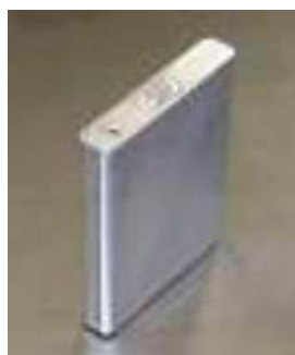
Figur 5. För att erhålla högkvalitativa, porfria lasersvetsar vid tillverkning av NiH-batterier kombineras en pulsad Nd:YAG-laser med en cw diod-dito.
