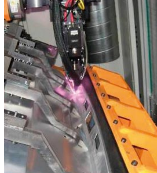
Figur 14. Svetsverktyg med taktill sensor för fogföljning vid lasersvetsning av Audi Q5-modellens baddörr utförd med en 4 kW diodlaser.
