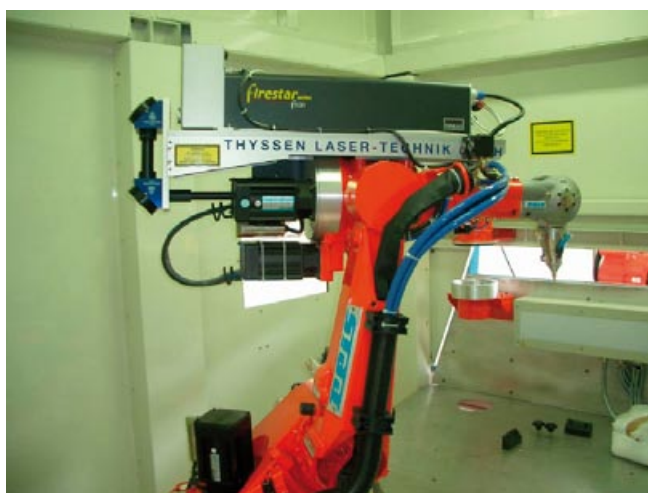
Figur 9. Reis Lasertecs patenterade lösning med en CO 2 -laser monterad direkt på robotarmen. I det här fallet rör det sig om en placering på robotens 3:e arm, men man har en motsvarande lösning för montering på robotarm nr. 2.
