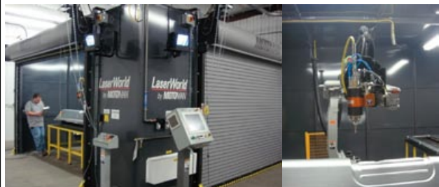
Skärning av hyttprodukter till brandbilar med ett system tillverkat av Motoman med Precitec YRC skärhuvud.
