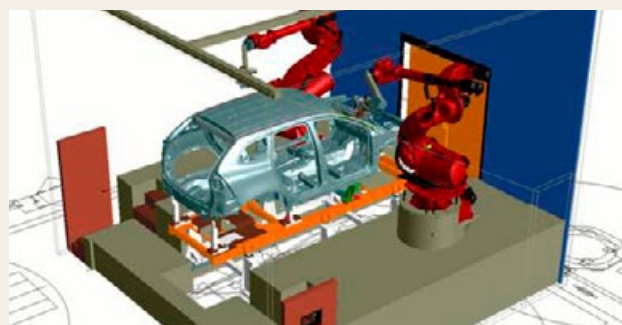
Figur 3. Schematisk layout över den nya lasersvetsstationen, vilken betjänas av en diodpumpad Nd:YAG-laser och en dito Yr:YAG-skilaser, båda med 4 kW effekt.
