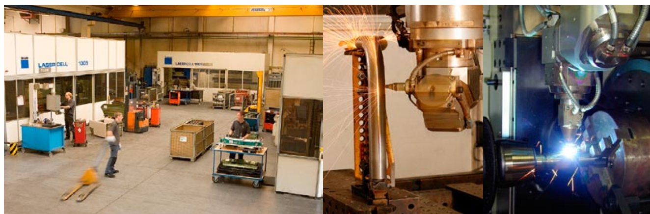
Figur 15. Ovan tre av de fem lasermaskinerna hos VIA Lasertec GmbH, och t.h. pågående legoarbeten för laserskärning resp. svetsning.
