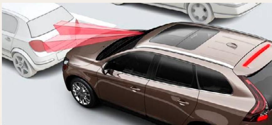
Figur 1. Så fungerar Volvos CitySafety! Med hjälp av radar och kameror identifieras ett framförvarande fordon varpå inbromsning sker innan en kollision uppstår. Systemet är standard-utrustning för XC60-modellen och verkar i hastigheter upp till 30 km/t.
