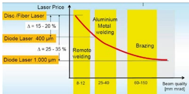
Figur 5. En kostnadsjämförelse mellan direktverkande diodlasrar och disk-/fiberlasrar samt vilken strålkvalitet som krävs för olika former av bearbetning.
