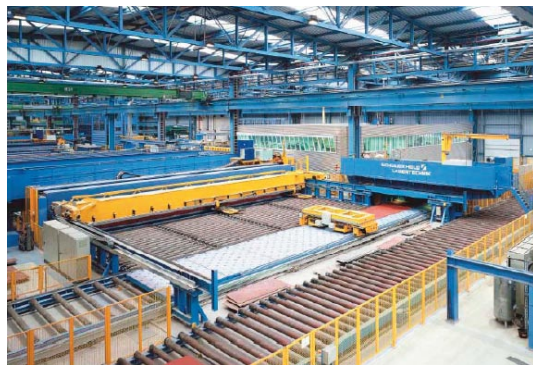
Figur 1. Laserhybridsvetsning av paneler hos "pionjär-varvet" Meyer Werft.
