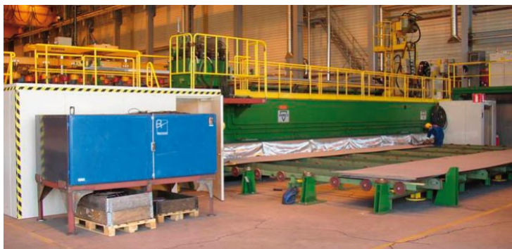
Figur 2. Laserhybridstationen vid Aker Yards i Turku (Åbo) baserad på en 6 kW fiberlaserenhet.
