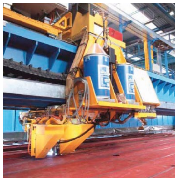
Figur 1. Laserhybridsvetsning av paneler hos "pionjär-varvet" Meyer Werft.
