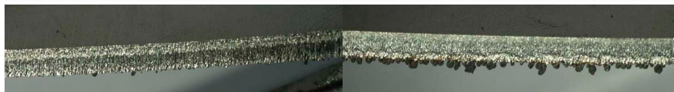
Figur 37. Skärresultat för 2 mm tjockt rostfritt material; en jämförelse mellan professor Olsens "Multi-beam"-teknik överst och hur resultatet blir vid konventionell fiberlaserskärning.
