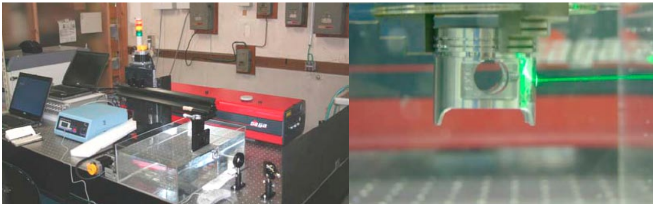
Figur 33. Laserblästring under vatten med grönt ljus (våglängd = 532 nm).
