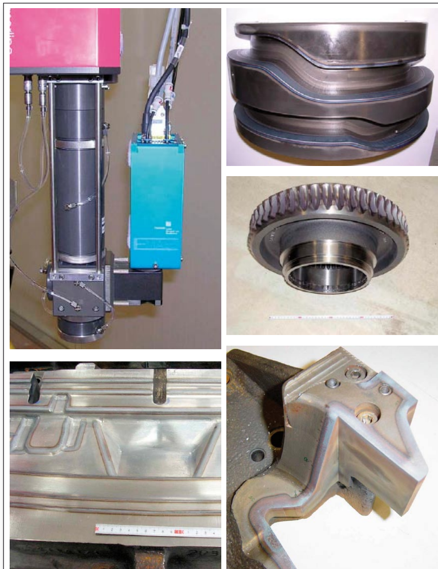
Figur 26. T.v. Effektövervakningsverktyget "LompocPro" med integrerad E-MAqS-kamera som mäter temperaturen kring fokuspunkten på arbetsstycket, och några exempel på applikationer som förstärkts med hjälp av laserpåläggning; kamaxel, kugghjul, skärverktyg och ett pressverktyg.
