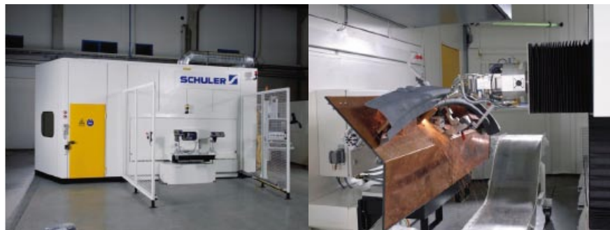
Figur 4. Exteriör och interiör bild från en av laserskärstationerna i VWs Kasselfabrik för trimskärning av varmformade detaljer. Längst t.h. skimtar Schulers MOBILAS-maskin.
