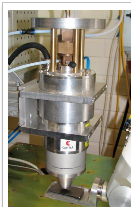
Figur 24. Munstycke med koaxiell pulvertillförsel avsett för laserpåläggning utvecklat i samarbete mellan Tampere University of Technology och Cavitar Ltd.
