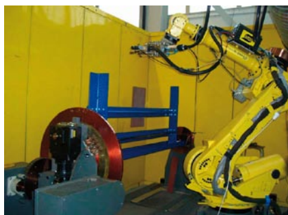
Figur 13. Interiörbild från SLV's mobila laserzell utrustad med Fanuc-robot och RoboFeed-matarverk från ESAB avsedd för reparationsskärning och -svetsning.
