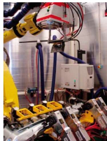
Figur 9. Industriell validering av "Remote Laser Welding" hos Peugeot i Mulhouse. T.v. detaljerna inspända i fixtur och t.h. klart för svetsning!
