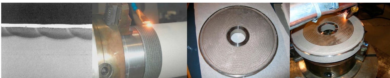
Figur 35. Tekniken för ”Laser Fusing” där ett genom termisk sprutning pålagt material smälts in i grundsubstratet. T.h. några applikationsexempel utförda vid FORCE Technology; cirkulär platta med 400 mm diameter och en vevaxel med 200 mm dito.
