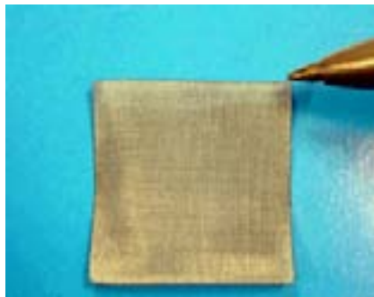
Figur 2. Rena och snygga skärkanter på ett finmaskigt, rostfritt nät som laserskurits med en effekt på 100 W och en hastighet av 300 inch/min, eller ungefär motsvarande 7,62 m/min.
