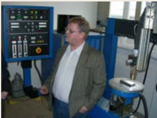
Kari Westerling berättar om PTA-påsvetning och demonstrerar den koaxiella pulvermatningen. T.h. PTA-påsvets.
