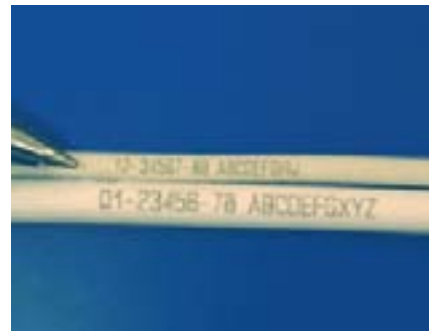
Figur 3. Hög kontrastverkan erhöles vid laser-märkning av elektriska kablar belagda med isolermaterial i form av kiselgummi [den mindre] respektive PVC.
