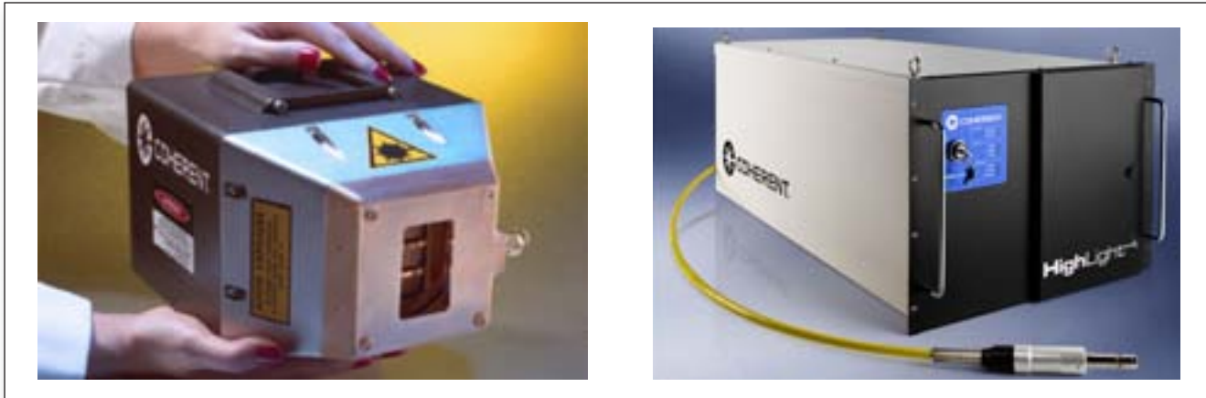
Figur 7. Existerande högeffekt direktdiodlasersystem exemplifieras med Coherent HighLight 4000L (t v) som ger 4 kW (linjeformad) uteffekt mha fast optik, idealisk vid påsvetsning av stor yta och med hög depositions hastighet, och Coherent HighLight 1000F (t h, som ger 1 kW uteffekt via fiber, vilket bäst passar för precisions-påsvetsning av komponenter med varierande geometri.
