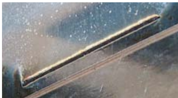
Figur 22. Fixering av komponenterna till ett transformatorhus hos firman Käßpler & Pausch, och t.h. en närbild på en av många lasersvetsar i denna produkt.
