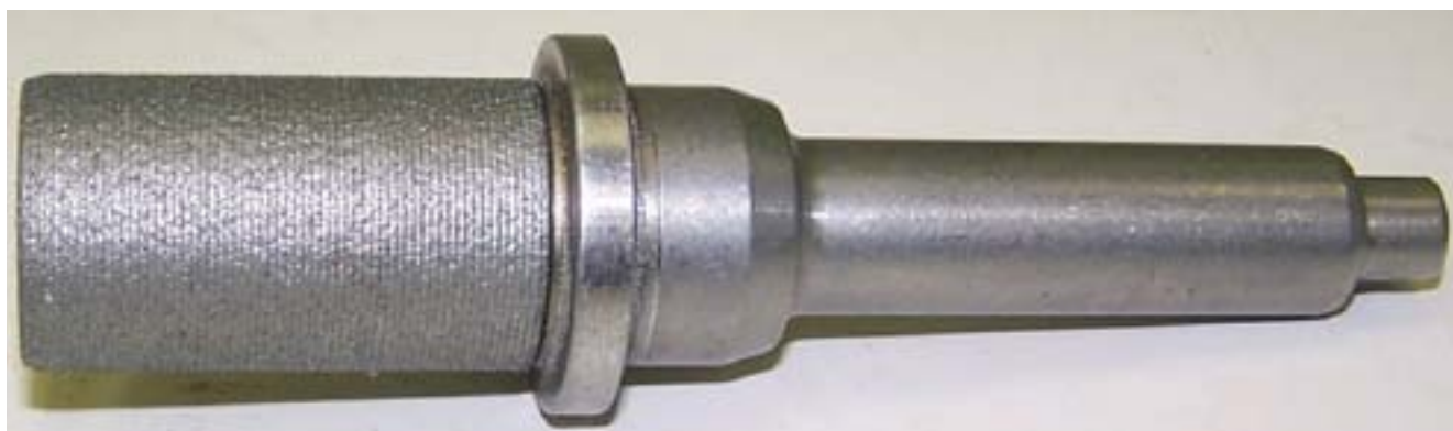
Figur 10. Laserspåsning av axeltapp med Inconel 625.
