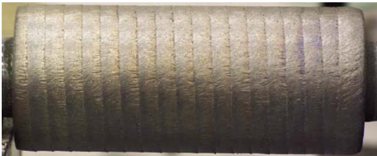
Figur 9. Tryckrulleaxel påsvetsad med Höganäs C22 Hastelloy.
