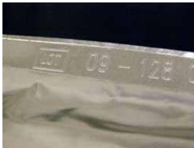
Figur 2. Denna närbild visar det reliefintryck som fås p.g.a. den något förhöjda märkningen på foliepåsens yttre plastskikt.
