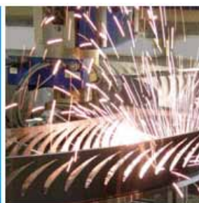
Figur 5. ERLASER®WELD Rotation – en högproduktiv och kostnadseffektiv lösning för lasersvetsning av detaljer med hög komplexitet.
