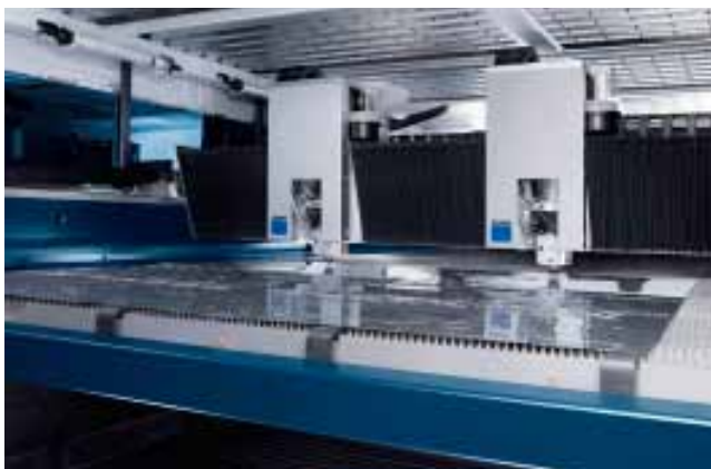
Figur 5. Några laserskärsystem från Trumpf; t.v. den disk-laserbaserade TruLaser5030 för tunnplåtsskärning, medan det fortfarande är CO 2 -lasrar som gäller vid grövre dimensioner, här illustrerat med TruLaser3030 (t.h.).
