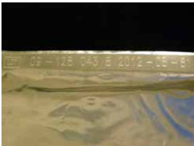
Figur 1. Denna produkt-ID märktes med 25 W lasereffekt och en processhastighet på 254 mm/sek vilket innebär att hela märkningsoperationen tog blott 1,03 sekunder.
