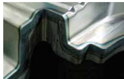
Figur 3. ERLASER®TCH för temperaturkontrollerad laserhårdning av främst verktyg och formar, där hårdzonen övervakas av en tvåfärgspyrometer. Typiska värden för spårbredd och hård djup är 5-40 mm resp. 0,2-1,5 mm.
