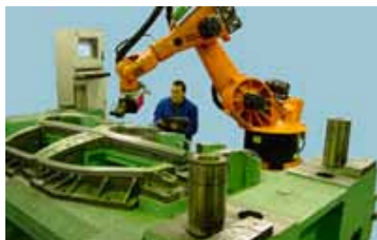
Figur 3. ERLASER®TCH för temperaturkontrollerad laserhårdning av främst verktyg och formar, där hårdzonen övervakas av en tvåfärgspyrometer. Typiska värden för spårbredd och hård djup är 5-40 mm resp. 0,2-1,5 mm.
