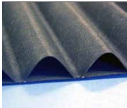
Figur 4. Den svarta 15 kg-varianten med 12,7 mm höga korrugeringar och 25,4 mm c/c-avstånd kunde laserskäras med 142 W effekt.
