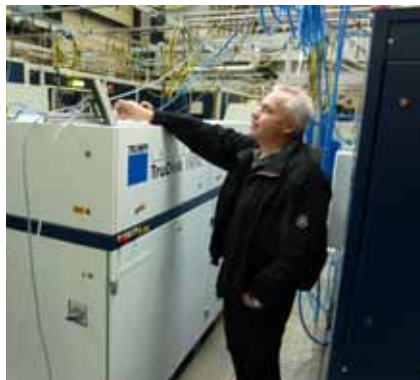
Bild 13. Esa Laurila tittar närmare på manöverpanelen till den 16 kW disklasern som finns hos LZH. Notera härvarna med fiberoptik som hänger under taket.
