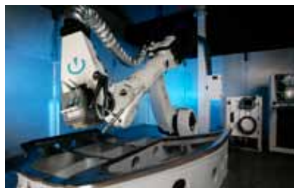
Figur 3. ERLASER®TCH för temperaturkontrollerad laserhårdning av främst verktyg och formar, där hårdzonen övervakas av en tvåfärgspyrometer. Typiska värden för spårbredd och hård djup är 5-40 mm resp. 0,2-1,5 mm.
