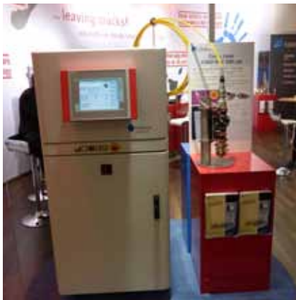
Bild 9. 4 kW diodlaser från Laser Line kan fokuseras till 0.3 mm stråldiameter. Strålen överförs i en fiber med diameter 300 µm.
