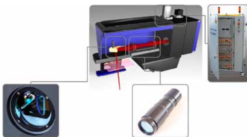
Figur 3. Några av de ingående komponenterna i ett flexibelt "remote"-system med bl.a. lättvikts-speglar för snabba rörelser speciellt vid RLC, samt "zoom-optiker" vilka innehåller juster-bara kollimerings- och fokuseringslinser för variabel brännvidd och fokalkpunktsdiameter.
