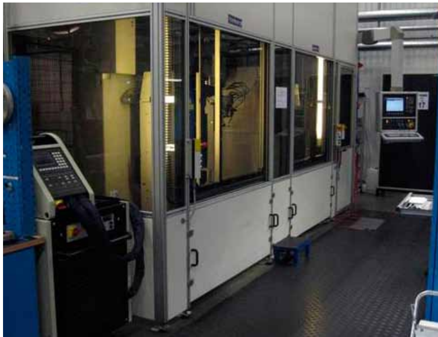
Bild 4 . Svetscellen består av en Trumpf TLC 1000 med 6 kW CO 2 laser och två svetsstationer.
