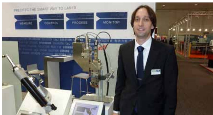
Bild 8. Wobble Tracker från Precitec KG har integrerad fogföljning och programmerbar wobbling (scanning) av laserstrålen tvärs svetsriktningen, berättar Andrey Andreev. På så sätt optimeras laserstrålens storlek för varje foggeometri och spaltstorlek.
