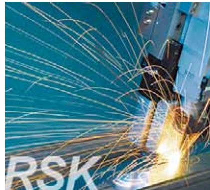
Bild 17. HIGHYAG svetsprocessverktyg RSK har tryckrulle eller tryckfinger för fixturering av plåtar vid överlappssvetsning.
