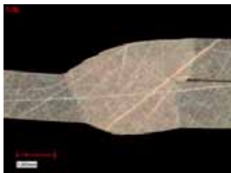
Figur 12. Diodlasersvetsning av aluminiumbakdörren till Audi Q5-modellen; en utmaning såtillvida att fogens geometri förändras över dörrens bredd från en strålfällegeometri, via en kantfog till en överlappsdo.
