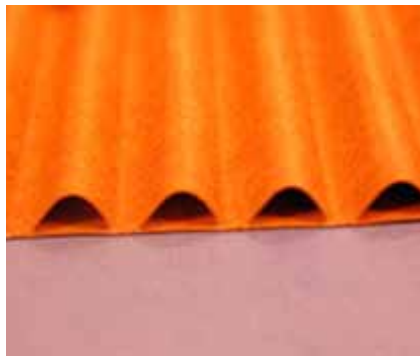
Figur 3. 10 kg-varianten av korrugerad kartong med 9,5 mm höga korrugeringar på 19 mm c/c-avstånd skurna med 109 W effekt och 9,15 m/min i skärhastighet.
