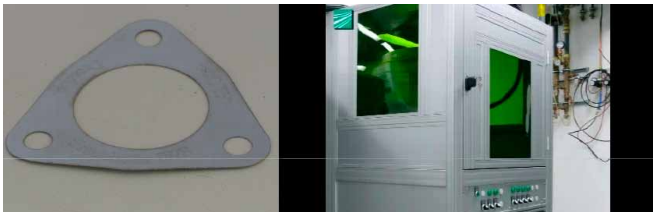
Figur 8. Exempel på RLC av 0,1 mm tjockt rostfritt material utfört i en dedikerad maskin (t.h.) hos IWS i Dresden. Skärhastighet 350 m/min!
