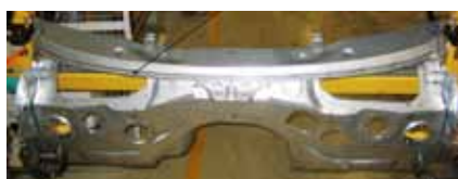
Figur 22. Plumbalken till nya BMW 1-serien lasersvetsas med två 1.297 mm långa kontinuerliga lasersvetsar för att garantera en hög vridstyvhet och täthet mot läckage.
