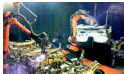
Figur 22. Plumbalken till nya BMW 1-serien lasersvetsas med två 1.297 mm långa kontinuerliga lasersvetsar för att garantera en hög vridstyvhet och täthet mot läckage.
