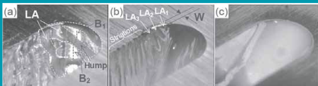
Figur 12. Observationer från höghastighetsfilming vid laserskärning av 3 mm tjockt lågkolhaltigt stål; Låga hastigheter ger upphov till "humping"-effekter och vid 3 m/min uppstår de karaktäristiska bandmönstren vilka försvinner vid 6/ min då såväl skärfront som – sidor blivit stabila.
