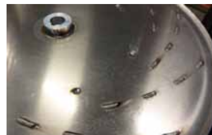
Figur 5. Laserskuret och lasersvetsat fläkthjul
