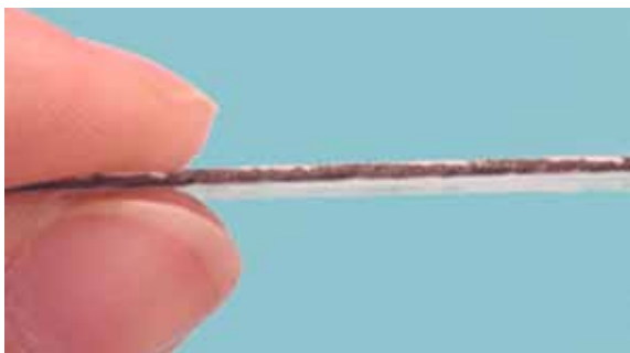
Figur 2. Vävt PMC-material som laserskurits med luft som skärgas.
