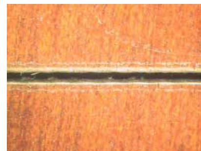
Figur 15. 14 mm tjocka fenolhartsbaserade laminat-bräder; skurna med 3 kW lasereffekt och en skärhastighet på 3,5 m/min, och med luft som skärgas; 5 bars tryck t.v. och 10 bar längst t.h.
