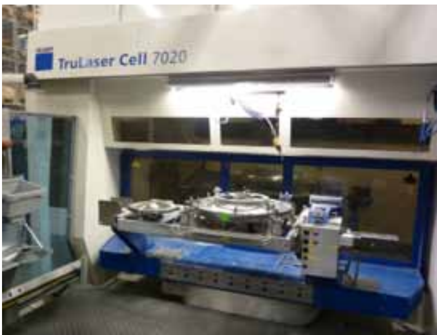
Figur 6. Laserskärning och lasersvetsning av fläkthjulen sker i en TruLaser cell 7020 med 6 kW CO 2 -laser.
