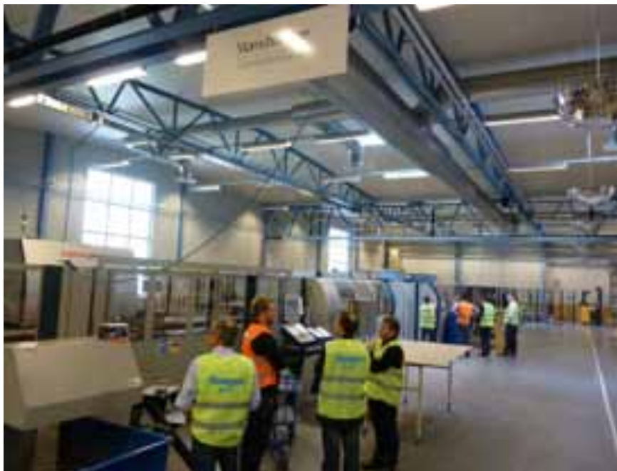
Figur 8. Stans- och bockningslinje från Salvagnini installerades i en ny lokal 2011. I slutet av linjen finns en robot som staplar de färdiga luckorna.
