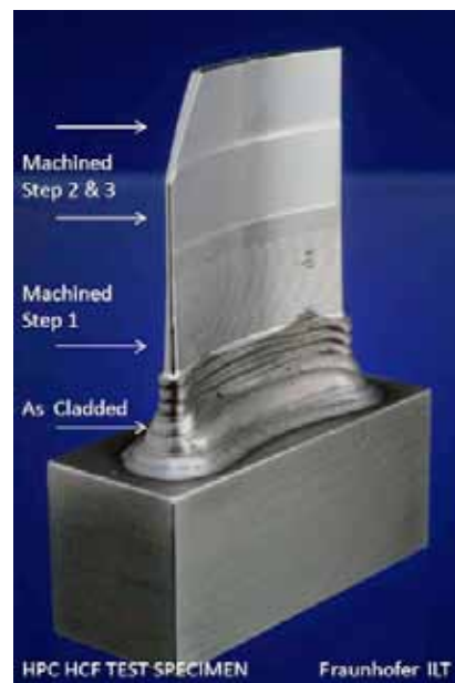
Figur 20. Reparation av s.k. "BLISKS" utförs idag med "Ultra High Speed LMD". Th. illustreras de olika arbetsmomenten.
