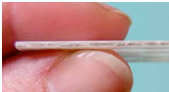
Figur 3. Genom att byta till högtrycksnitrogen kan förkolning av skärkanten minskas.
