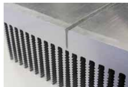
Fig. 19. Även vid förhållandevis kraftiga godstjocklekar hos aluminiumplåtar går det att identifiera skillnader i deformationsbeteende kopplat till tjocklekskillnader. T.h. syns MPNG-metoden applicerad på kylkanalprofiler avsedda för ett motorpaket till höghastighetståg.
