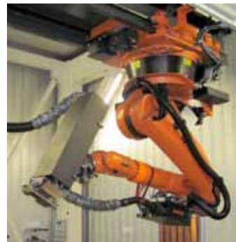
Fig. 39. VW:s kombinerade tillverkningscell för laserhårdning och -påläggning i Wolfsburg med en detaljbild på det robotburna hårdningsverktyget t.h.
