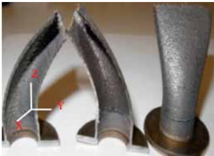
Fig. 1 e: Typisk komponent (air vent, rostfritt stål, 1 mm vägg) tillverkad med LAM.
