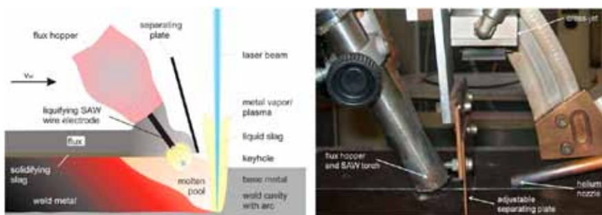
Fig. 22. Principskiss (t.v.) och försökupställning vid kombinerad laser- och pulverbågsvetsning, där den s.k. separationsplattan är en viktig ingrediens för att förhindra pulver att interferera med laserstrålen.
