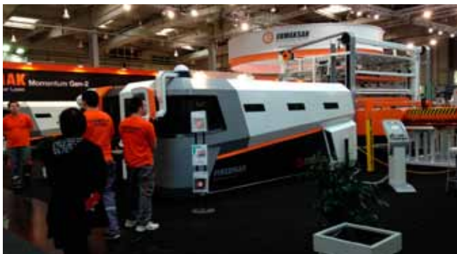
Fig. 5. Ermaksan – Fibermak med 2 kW fiberlaser
