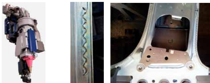
Fig. 22. Med TKSE:s nya "scanner"-verktyg kan man skapa z-formiga svetsmönster vid svetsning av karossdetaljer som nedre B-stolpe t.h.
