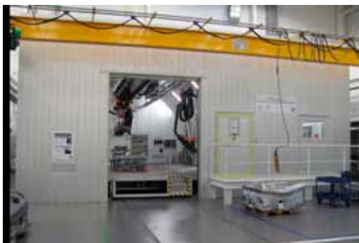
Fig. 39. VW:s kombinerade tillverkningscell för laserhårdning och -påläggning i Wolfsburg med en detaljbild på det robotburna hårdningsverktyget t.h.
