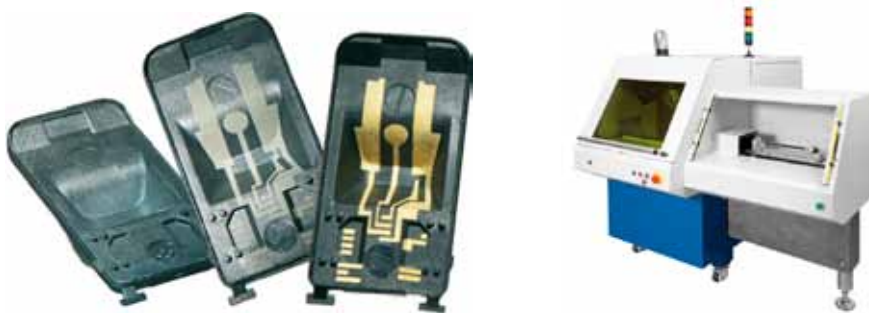
Fig. 14. Strukturering och metallisering av komplexa ytor kan utföras med en "Fusion 3D 1500", vilken arbetar med pulsfrekvenser mellan 10-200 kHz. Maskinen mäter 1740×1880×1680 mm och den maximala processhastigheten vid strukturering ligger på svindlande 4000 mm/s.
