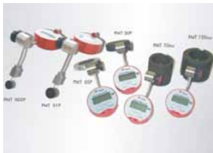
Mätpuckar från Primes. Noggrannhet +/- 4% (Absolut) Noggrannhet +/- 2% (Relativ)
