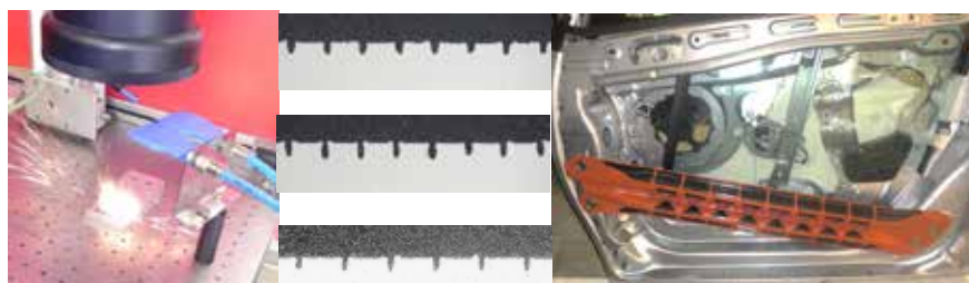
Figur 42. Ett intressant koncept för att foga plastmaterial till en metall var att först med "scanner"-verktyget "IntelliScan" och IPG-lasern "YLS-1000-SM" skapa fördjupningar i metallen, varpå plastmaterialet smältes ned i dessa för att skapa en bättre förbindning. Konceptet hade sedan använts på en Peugeot-dörr för att tillverka en krockbalk bestående av en glasfiberförstärkt polyamid och ett DP1000-stål.
