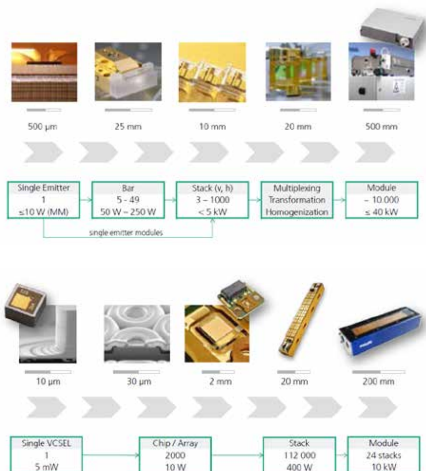
Figur 13. Två olika angreppssätt då det gäller att kombinera diodelement till diodlasrar med multi-kW-effekt; Överst det traditionella där laserstrålningen emitteras från halvledarelementens kanter och underst ett s.k. VCSEL [Vertical-Cavity Surface-Emitting Laser diodes]-system.
