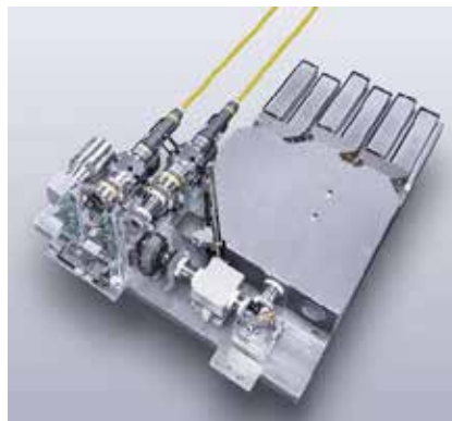
Figur 11. En modul till en av Trumpfs diodlasrar i deras TruDiode-serie. Den är uppbyggd av sex diodstaplar där tre olika våglängder kombineras med en effekstabilitet på \pm 1\% .
