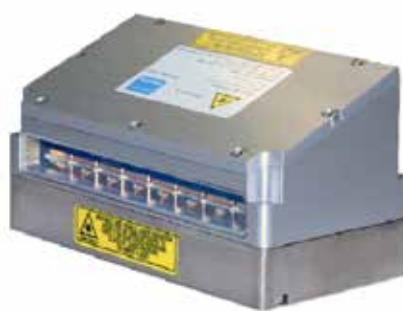
Figur 23. Med denna kompakta typ av diodlaserkälla från JENOPTIK, där man har sammankopplat 8 stycken diodstaplar à 100 W, kann man skapa en skräddarsydd brännfläck på 100×1 mm.
