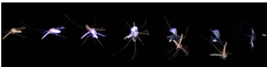
Figur 9. En bildsekvens från höghastighetsfilmning av hur en laserpuls med en energitäthet kring 2 \text{ J/cm}^2 kan sönderdelar en malariafluga.
