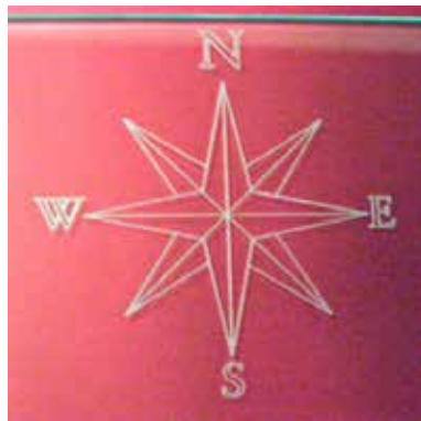
Figur 2. Denna 102 × 110 mm stora bild av en kompassros märktes på glas med 60 W lasereffekt och en process hastighet på cirka 127 mm/sek då man använde en fokuseroptik med 370 mm brännvidd. Referensbokstäverna N, S, E och W mäter 10 mm i höjd.
