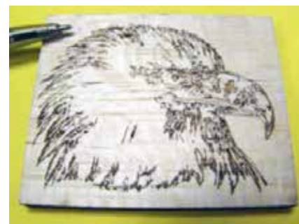
Figur 3. Lasermärkningen på detta balsaträ resulterade i en ren och skarp gravering. Bilden av örnen märktes med 25 W laser-effekt under en cykeltid på 4,28 sekunder.
