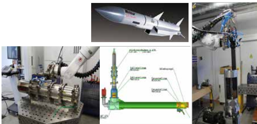
Figur 11. Lasersvetsning av en gasgenerator avsedd för medeldistansroboten "Meteor" där den invändiga svetsningen utförs med ett specialutvecklat verktyg från Nutech.
