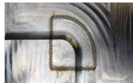
Figur 17. Ett uppläggningsbord i INVAR-material tillverkat i 10-15 mm tjocka moduler som sammanfogats med fyra stycken 8 meter långa lasersvetsar. Lasersvetsning kan också användas vid reparation av uppläggningsbordet (t.h.).
