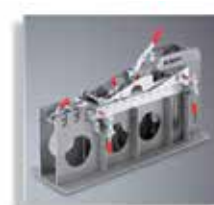
Bild 4. Fixtureringstekniken är en nyckel till framgångsrik lasersvetsning av plåtprodukter. Speciellt fixturer av plåt erbjuder många innovativa kostnadseffektiva lösningar för små och medelstora serier. Källa: Trumpf
