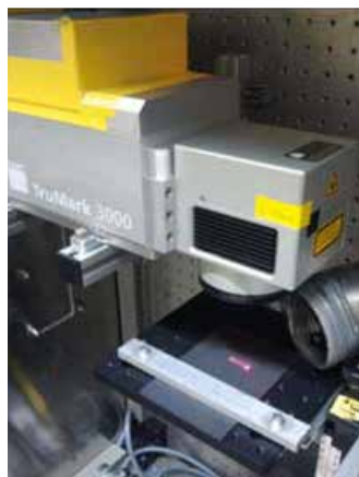
Figur 15. Märklasern TruMark3230 från Trumpf kan även användas för att ablationsskära fiberförstärka polymerer som det 1,5 mm tjocka exemplaret t.h. som skurits med en tudelad laserstråle och fem repetitioner.
