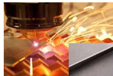
Figur 48. Just nu tittar TeraDiode på att utveckla diodlaser-källor med kortare våglängder (500 och 800 nm), vilka är särskilt lämpade vid bearbetning av starkt reflekterande material som aluminium, koppar och mässing.
