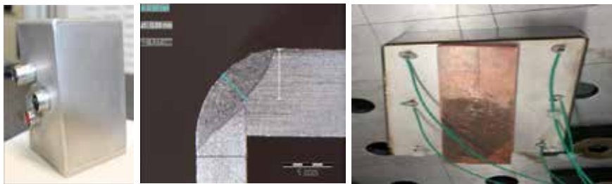
Figur 13. Höljet till en elektronikenhet värmeledningssvetsas med en diodlaser där ett antal sensorer (t.h.) kontrollerar att temperaturen aldrig överstiger 85°C för att begränsa värmedistorsioner.
