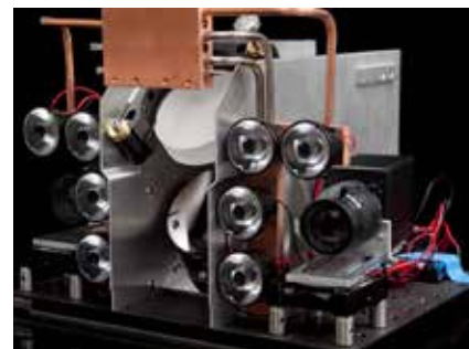
Figur 8. T.v. principen för ett s.k. fotoniskt stängsel och t.h. prototypen till det verktyg som är tänkt att identifiera malariaflugan och därpå döda densamma med ett antal laserpulser.
