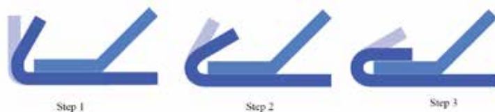
Figur 9. Illustrationer av rullfalsningsprocessen som görs i tre steg (ovan), och där man förvärmer med laser i samband med det slutliga formningssteget.
