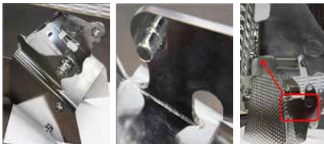
Figur 12. Höga krav på svetskvalitet föreligger vid tillverkningen av denna mätvåg i rostfritt stål som sammanfogas med en 6 kW diodlaser.
