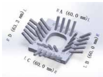
Figur 25. T.v. syns den använda testgeometrin och överst t.h. den uppbyggda gitterstrukturen med 2,0 mm nätstruktur, vilken var betydligt lättare att lösgöra från trapezoidplattan jämfört med rörstrukturen ( \Delta 1,45 mm) därunder.
