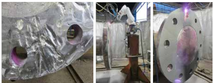
Figur 23. Laserpåläggning med Inconel625 på flänsen till en mellandrivaxel tillverkad i C45-material. Längst t.v. den nerslipade, skadade ytan, och närmast utseendet efter fullbordad reparation.
