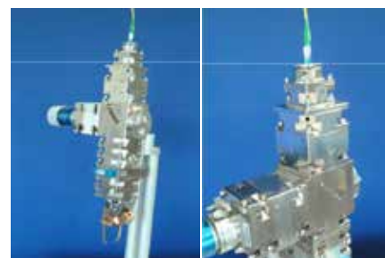
Figur 52. Precitecs "IDM"-verktyg för kontroll av penetrationsdjupet vid lasersvetsning kan fås integrerat i svetsverktygen "YW52" och "YW30".
