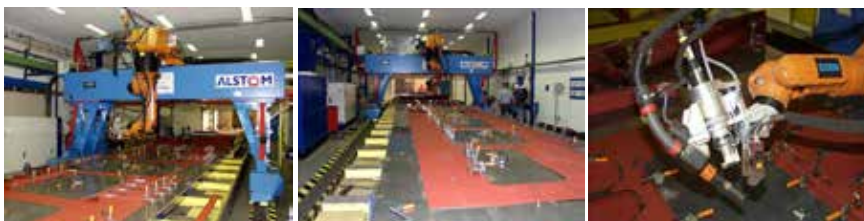
Figur 38. Laserhybridanläggning hos företaget Alstom för tillverkning av sidoväggar för järnvägsvagnar. Längst t.h. syns laserhybridverktyget och svetsmetoden ger minimala värmeförvridningar.
