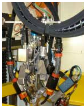
Figur 6. Svetsverktg försett med fogfölj- ning och en trådmattningsenhet för kalltråd, vilken bidrar till att minimera värmeförlusten vid laserhybrid-svetsning av hydrauliska hanteringskranar.
