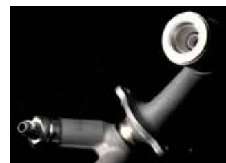
Figur 28. GE tillverkar över 5000 s.k. LEAP-motorer om året där var och en innehåller 19 insprutningsmunstycken. De senare kommer från 2016 att tillverkas med LAM-teknik och därmed ersätta den gamla konstruktionen som bestod av 15 separata detaljer.
