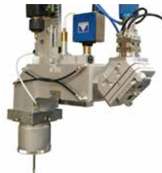
Figur 51. Några av de produkter som visades upp på AKLs leverantörsutställning var Scansonic's adaptiva fjärrlaserverktyg närmast, och Precitecs "CoaxBrazer" (t.h.) med koaxiellt matad tillsatsstråd vilket medger riktningsoberoende laserlödning.
