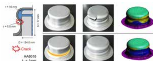
Figur 3. Genom att använda en mellan-uppvärmning med laser vid denna tvåstegsformning (undre raden) kan man undvika den sprickbildning som annars upp-kommer i aluminiummaterialet (övre raden).
