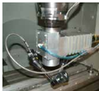
Figur 29. T.v. försökssupställningen med pyrometer för temperaturkontroll och t.h. en sprängskiss på laserverktyget.
