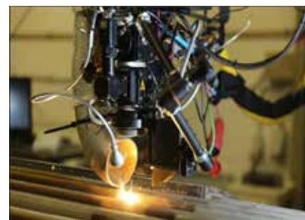
Figur 18. I en värmeväxlare för biomassa lasersvetsas 75 rör till den invändiga mantelytan. Svetsningen görs intermittent och i en viss sekvens för att minimera värmedistorsioner.
