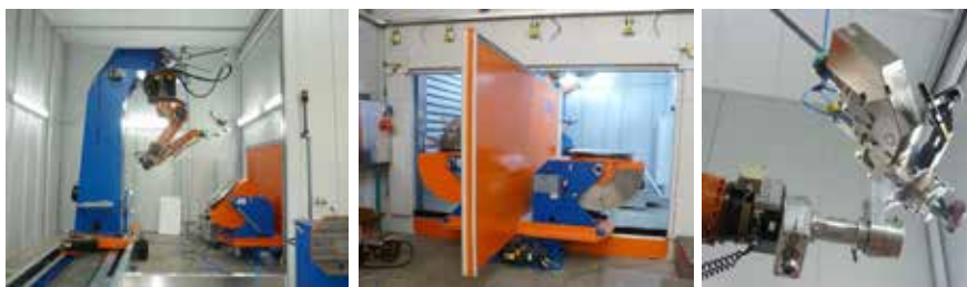
Figur 8. Lasercellen i Cloos' applikationslaboratorium är utrustad med robot plus lägesställare vilket medger 8-axlig laserbearbetning med t.ex. Precitecs "Wobbler"-optik för strålpending (t.h.).
