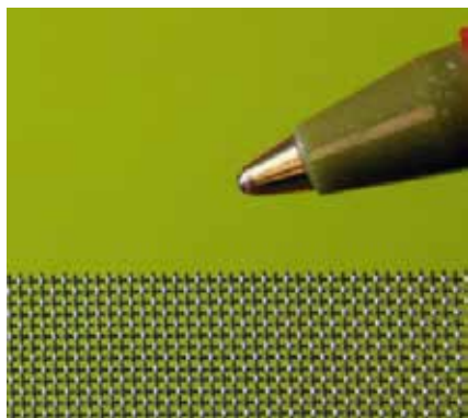
Figur 1. Denna rena snittkant av ett 0,28 mm tunt nätverk i rostfritt stål skars med 200 W lasereffekt vid en framföringshastighet på 5 m/min och där ren luft användes som assistgas med ungefär 5,5 bars tryck.
