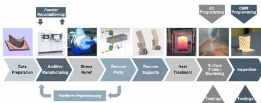
Figur 18. Att ha kontroll över hela processkedjan vid SLM-tillverkning poängterades i flera föredrag, och kan innebära avsevärda kostnadsbesparingar.
