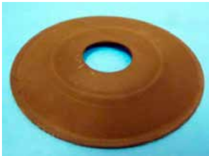
Figur 2. Det 22,9 mm stora centrumhålet i detta tätning- membran laserskars med 80 W och en process- hastighet på 74 mm/sek [175 IPM].
