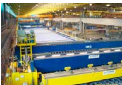
Figur 9. Stationen för stumsvetsning av fartygspaneler hos det italienska skeppsvarvet Fincantieri. Anläggningen har en integrerad kantfräs, och ovan t.v. syns det mobila svetsverket från IMG.
