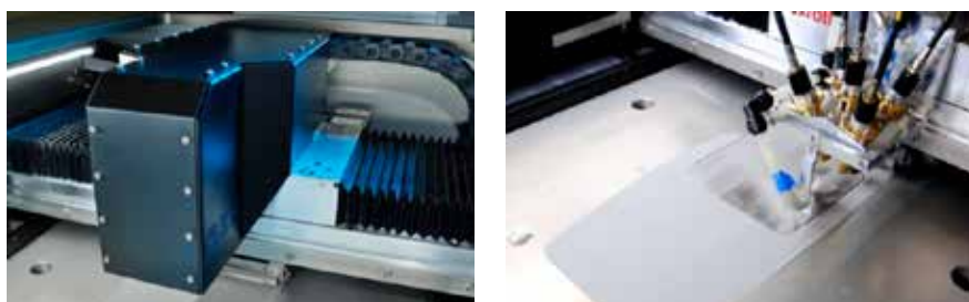
Figur 7. Denna "multi-spot"-variant av en SLM-maskin möjliggör såväl högre produktivitet som rationell ytbeläggning av större ytor.
