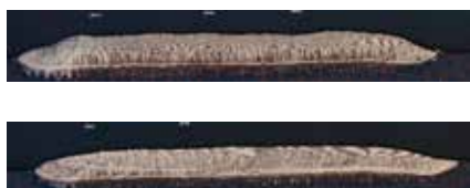
Figur 35. Genom att omsmälta det tidigare lagda CMSX-4-skiktet kan man få en mer homogen orientering av materialets dendritstruktur, vilket framgår av den undre bilden.
