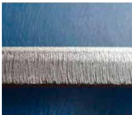
Figur 4. Oxid- och gradfritt laserskärnitt av 6 mm tjock fartygsplåt med primad yta; 6 kW effekt och 4 m/min i skärhastighet.
