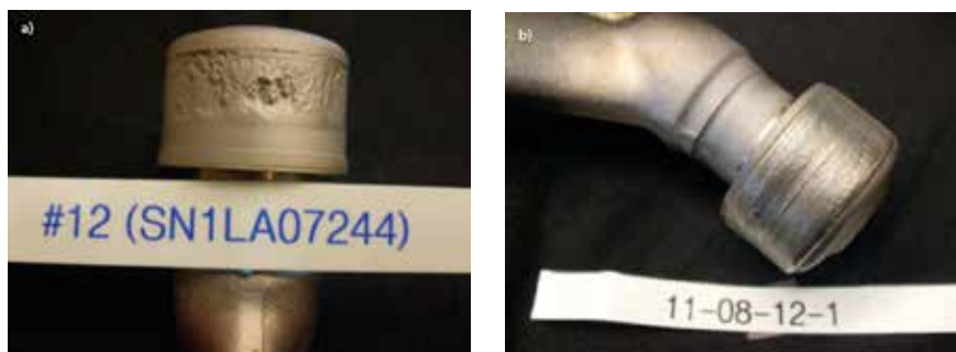
Figur 4. a) Ett skadat bränsleinsprutningsmunstycke för motorer av typen RR501K b) Samma munstycke efter reparation med laserpåläggning
