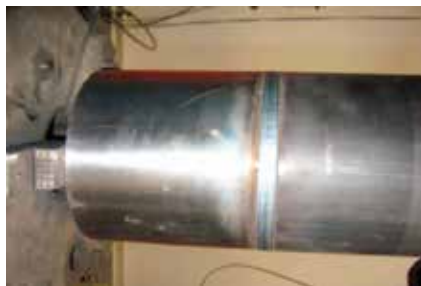
Figur 11. Laserhybridsvetsning av hydraulikcylindrar med en vägg tjocklek på 12 mm; Lasereffekt 10 kW och svetsastighet 1,8 m/min.
