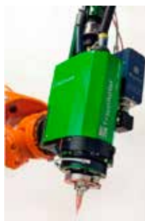
Figur 36. Verktöget COAXwire är avsett för laserpåläggning med tråd. Laserstrålen delas upp i tre strålar med 40° infallsvinkel och trådutsticket är 85 mm. Längst t.h. ses kollisionsskydd (1), injusterings av trådens läge (2), "cross-jet" (3) och "down-jet" (4).
