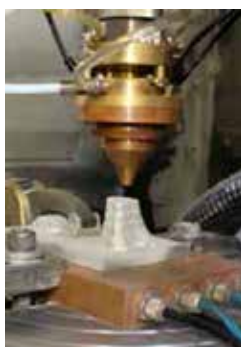
Figur 28. Ett exempel på "bionic design" där laserparametrarna vid SLM valts på ett sådant sätt att man erhåller ett hårt ytskikt men en mer porös kärna.
