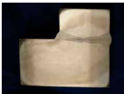
Figur 15. Dubbelsidigt svetsade kälfgögar i rostfritt material med 25 mm svetsdjup, där man pendlat laserstrålen för att på så sätt erhålla ett större svetsvärnsnitt. Processparametrarna var här 12 kW och en svetsastighet på 1 m/min.
