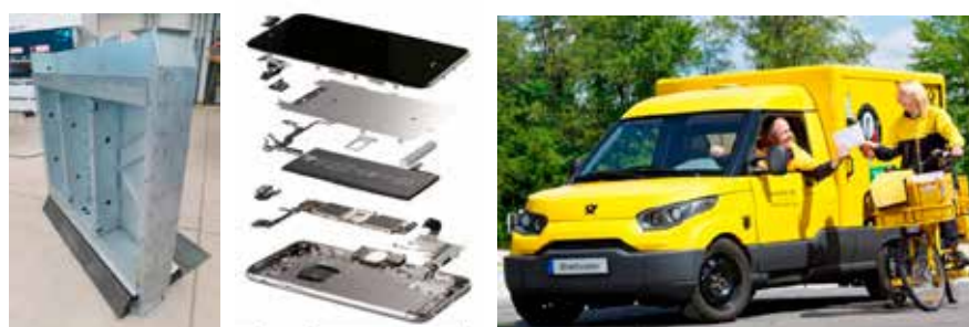
Figur 2. Trumpfs patenterade "K-fog" möjliggör en flänslös design vilken bl.a. används i Deutsche Posts lättviktsfordon "Street Scooter".
