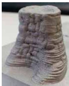
Figur 28. Ett exempel på "bionic design" där laserparametrarna vid SLM valts på ett sådant sätt att man erhåller ett hårt ytskikt men en mer porös kärna.
