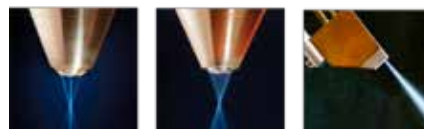
Bild 2. Två typer av koaxiella pulvermunstycken (t.v.) som ger minsta uppblandning samt sidomunstycke. Laserpåsvetsprocessen kan ge stängbredder på 0.5-32 mm i tjocklekar 0.5-4mm med en pulvereffektivitet på 80-98%.
