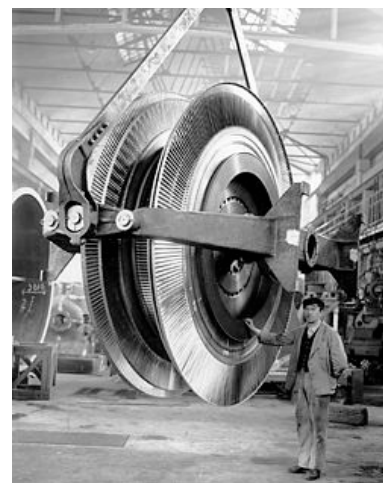
Bild 21. Turbinrotor till 50 MW Ljungströmturbin. Radialturbinhjul i centrum kombinerat med axialturbiner ytterst.
