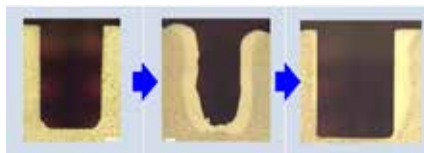
Figur 33. Övan principen vid rekonditionering av tätningskanaler, och längst t.h. en reparerad kolv efter 17.000 timmars drift med blott 0,01 mm förslitning.
