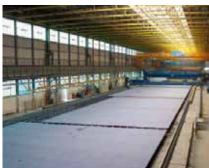
Figur 10. Helt plana paneler blir resultatet efter laserhybridsvetsning varför inga efterföljande rikttningsarbeten behöver utföras.
