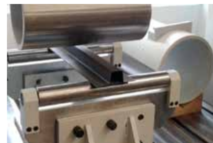
Figur 48. Genom lokal mjukgörning av presshårdade hattprofiler i Gestamps ”Flex Laser”-cell får man ett duktilt beteende vid 3-punkts böjprov och inga sprickor kring punktsvetsarna (inringat i grönt).
