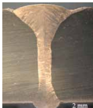
Figur 5. Laserhybridsvetsade fogar där fogberedningen gjorts med laserskärning; t.v. Invar-stålplåt i 8 mm tjocklek och t.h. skeppsbyggnadsstål i 10 mm.
