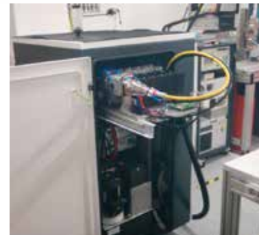
Figur 43. DF 040 HQ är den senaste produkten i Rofin-Sinars diod-laserserie där man multiplexar fem olika våglängder för att få en resulterande strålkvalitet på 25 mm*mmrad.
