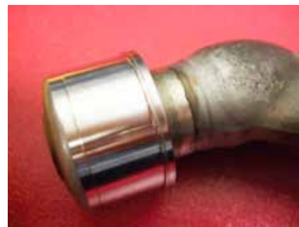
Figur 5. Ett genom laserpåläggning reparerat insprutningsmunstycke till en RR501K-motor efter kompletterande ytfinish.
