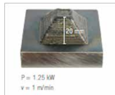
Bild 5. Precitec presenterar en ny lösning för trådmatning vid additiv tillverkning, CoaxCladder, där tråden matas koaxiellt inne i laserstrålen. Skyddsgas tillförs nu från sidan.
