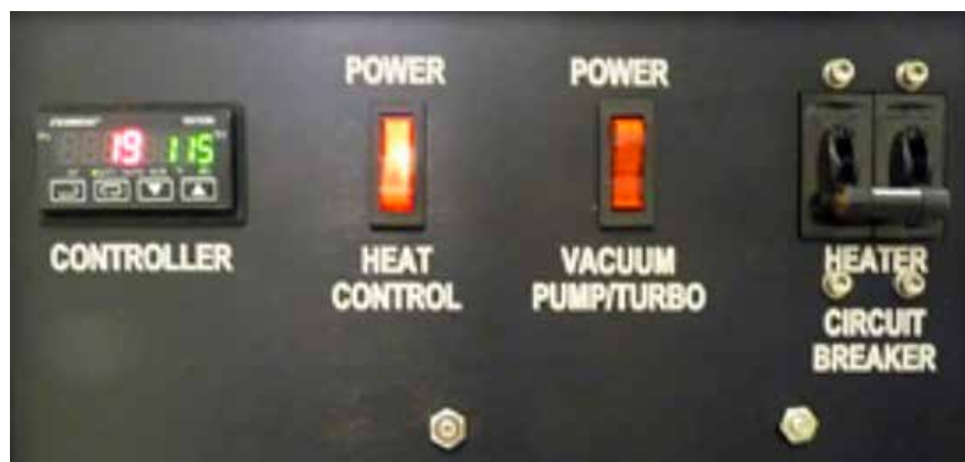
Figur 1. De fyllda bokstäverna på denna kontrollpanel märktes med 100 W lasereffekt och en processhastighet på 2.540 mm/sek [100 IPS] under inalles 9,6 sekunder.
