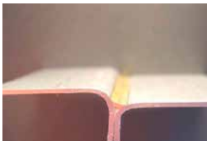
Figur 2. Laserlödda fogar av stålplåt utförda med fiberlasern YLS-5000-BR och en 600 µm grov processfiber. Tillsatsstråden är av CuSi-legering och lödverktuget Scansonics ALO3. T.v. 0,8 mm tjock zinkbelagd plåt laserlodd med 3,5 kW effekt och en framföringshastighet på 2,8 m/min, t.h. 1,5 mm tjock plåt lödd med 3 kW och en hastighet på 4 m/min.
