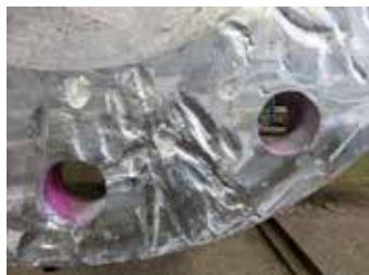
Figur 34. De förslitna ändflänsarna på en 9 meter lång drivaxel till ett tankfartyg rekonditionerades medelst laserpåläggning. Då axeln väger 25 ton använde Gall & Seitz Systems sin mobila enhet MoRU, vilken även kom till användning vid reparationen av drivaxeln till en kabeltrumma men då fick lov att hissas upp via en rörlig plattform då distributionsfibern från laserkällan visade sig vara 7 meter för kort.
