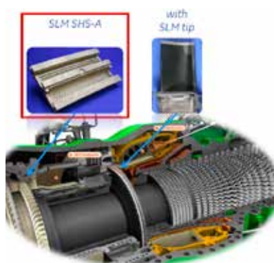
Figur 30. Några gasturbindetaljer tillverkade alt. reparerade med SLM-teknik; en värmesköld i materialet SHS-A med integrerade kylkanaler samt en försliten toppyta på ett HPT-blad.
