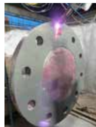
Figur 34. De förslitna ändflänsarna på en 9 meter lång drivaxel till ett tankfartyg rekonditionerades medelst laserpåläggning. Då axeln väger 25 ton använde Gall & Seitz Systems sin mobila enhet MoRU, vilken även kom till användning vid reparationen av drivaxeln till en kabeltrumma men då fick lov att hissas upp via en rörlig plattform då distributionsfibern från laserkällan visade sig vara 7 meter för kort.
