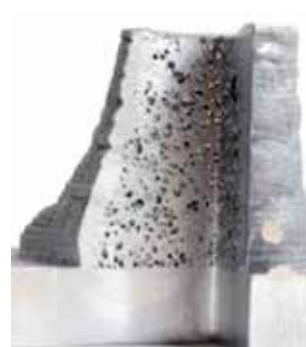
Figur 28. Ett exempel på "bionic design" där laserparametrarna vid SLM valts på ett sådant sätt att man erhåller ett hårt ytskikt men en mer porös kärna.
