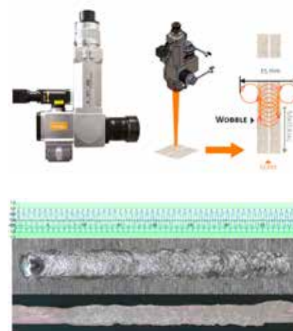
Figur 40. IPG har tagit fram ett verktyg där man med spegeloptik kan oscillera laserstrålen med hela 15 mm amplitud. Detta bidrar till att man kan svetsa aluminium porfritt även då höga lasereffekter används.
