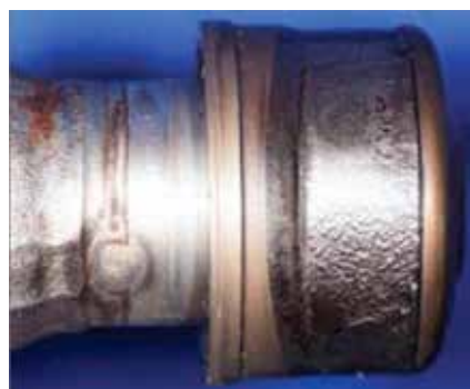
Figur 1. Ett skadat bränsleinsprutningsmunstycke för motorer av typ Rolls-Royce 501K.
