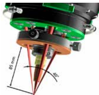
Figur 36. Verktöget COAXwire är avsett för laserpåläggning med tråd. Laserstrålen delas upp i tre strålar med 40° infallsvinkel och trådutsticket är 85 mm. Längst t.h. ses kollisionsskydd (1), injusterings av trådens läge (2), "cross-jet" (3) och "down-jet" (4).
