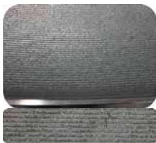
Figur 32. Cylindrar i SA508-material och en diameter på 2 m belades med rostfritt 316L. Skiktjockleken låg mellan 1,4-1,7 mm och påläggningsspåren lades med 50% överlapp.
