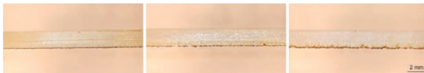
Figur 7b. Skärhastighetens inverkan på skärnittskvaliteten; fr. v. 70, 30 och 20 mm/sek. Konstanta parametrar var 100 W effekt, 4 bar assistgastryck och 50 kHz frekvens.
