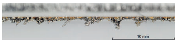
Figur 5b. För att minimera slaggformering bör laser-skärningen ske med hög effekt (4 kW) och högt gastryck (3,5 bar).
