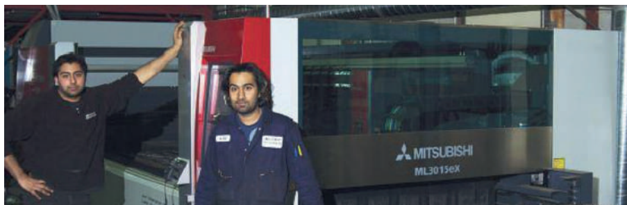
Figur 1. Junior Sehmbi (t.v.) tillsammans med storebror Mani framför den senaste investeringen, en fiber-baserad planskärmaskin på 3 kW. Verksamheten innefattar såväl skärning, bockning och slutfinish av produkter i material som rostfria eller lågkolhaltiga stål (t.h.).
