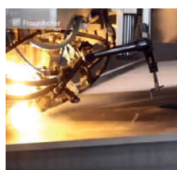
Figur 3. T.h. det specialutvecklade verktöget som möjliggör säker lasersvetsning i öppna verkstadslokaler. Det är försett med en trianguleringssensor som identifierar såväl fogens läge som dess utseende.
