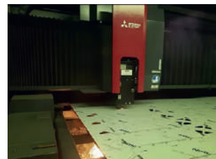
Figur 2. För majoriteten av företagets produkter räcker 3 kW lasereffekt gott och väl, och t.h. ser vi hur maskinen skär 2,6 mm tjock stålplåt.
