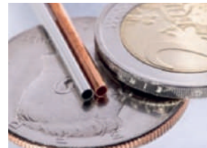
Figur 17. Med den specialutvecklade maskinen NanoWEMATM med integrerad ”grön” laserkälla svetsas såväl små rör i rostfritt och koppar, med hastigheter över 20 m/min, som kopparrör i värmeväxlare (t.v.).
