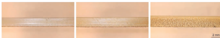
Figur 7c. Skärnitten för de tre Makrolon®-varianterna; fr.v. bas, UV-stabil och brandsäker, där den sistnämnda får en sämre snittkvalitet p.g.a. karbonisering av ingående additiv. Konstanta parametrar var 100 W effekt, 4 bar assistgastryck, 50 kHz frekvens och 70 mm/sek skärhastighet.
