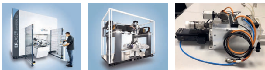
Figur 23. Den modulärt uppbyggda arbetsstationen ERLASER® Universal med 13 numeriska axlar för manipulering av laserstråle och arbetsstycke. T.h. det adaptiva svetsverktöget med integrerad OCT-funktion för fogföljning.
