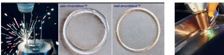
Figur 25. Ovan Prima Powers SmartRampTM med vars hjälp det går att undvika s.k. stopphål vid cirkulära svetsgeometrier, och t.h. SmartShieldTM som ger ett effektivt gasskydd via två separata gasflöden.
