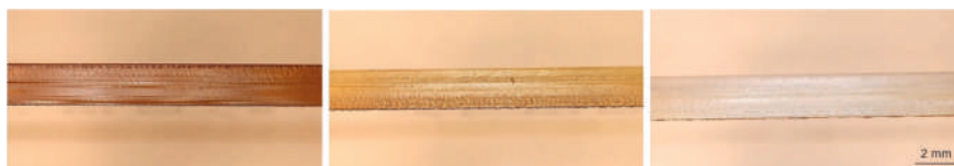
Figur 7a. Frekvensens inverkan på skärnittskvaliteten; fr.v. 1, 10 och 50 kHz. Konstanta parametrar var 100 W effekt, 4 bar assistgastryck och 70 mm/sek skärhastighet.
