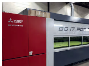
Figur 2. För majoriteten av företagets produkter räcker 3 kW lasereffekt gott och väl, och t.h. ser vi hur maskinen skär 2,6 mm tjock stålplåt.
