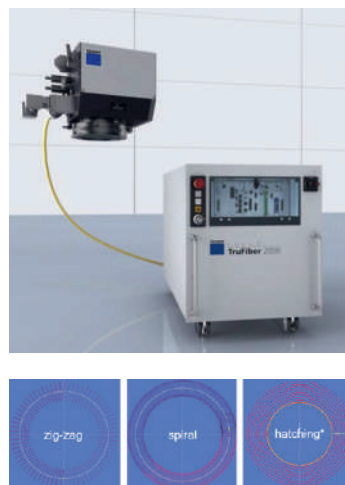
Figur 5. T.v. den SM-laser med tillhörande PFO 20-2-optik som användes vid cirkelsvetsningen, vilken utfördes i tre olika mönster; "zig-zag", "spiral" och "hatching".
