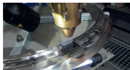
Figur 3. Rainer Oprei, som är teknisk direktör vid Eigelshoven, var initialt skeptisk till laserprocessen. Numera är han emellertid övertygad om LMD-metodens förträfflighet där det koncentriskt tillförda pulvret smälts samman med grundmaterialet i det skadade området.
