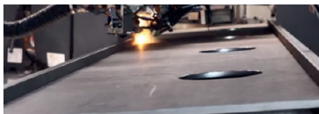
Figur 2. En av de stora fördelarna med Laser-MPNG jämfört med olika bågsvetsmetoder är den enklare fogberedningen varav också följer en avsevärt mindre förbrukning av tillsatsmaterial.
