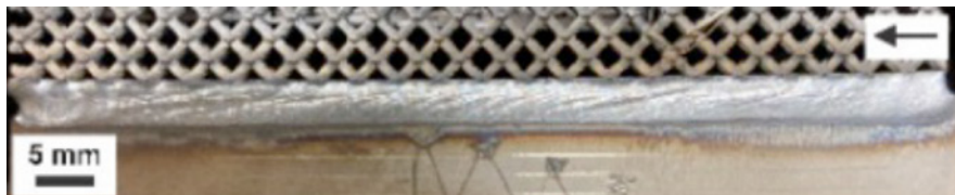
Figur 6: Svetsfog mellan en basplåt och en struktur framställd genom additiv tillverkning (AM) med laser powder bed fusion (PBF-LB).
