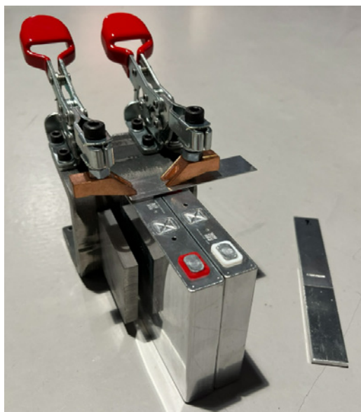
Figur 4: Battericeller monterade i en testfixtur där en busbar används för att sammankoppla cellerna med en så kallad cell-till-busbar fog. På bilden visas även en typ av testgeometri som används vid lasersvetsexperiment.
