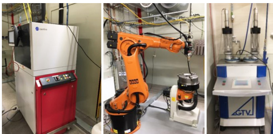
Exempel på laserkälla (diodlaser), hanteringsutrustning (robot och externaxel) med processverktyg samt pulvermatare som används vid laserpåsvetsning.
