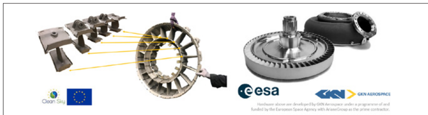
Fabricerad turbinstruktur till flygmotor samt komplett turbin till Prometheus, båda tillverkade med pulverbädd.
