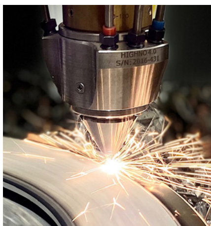
Höghastighetslaserpåsvetsning av bromsskiva.
