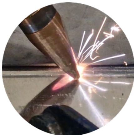
Figur 3: Sprut och rök vid användande av LightWeld för svetsning och rengöring.
