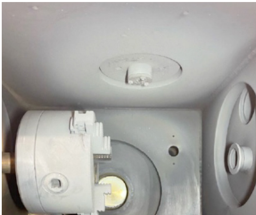
Figur 7: Vakuumkammare med damm som kommer från svetsprocessen.
