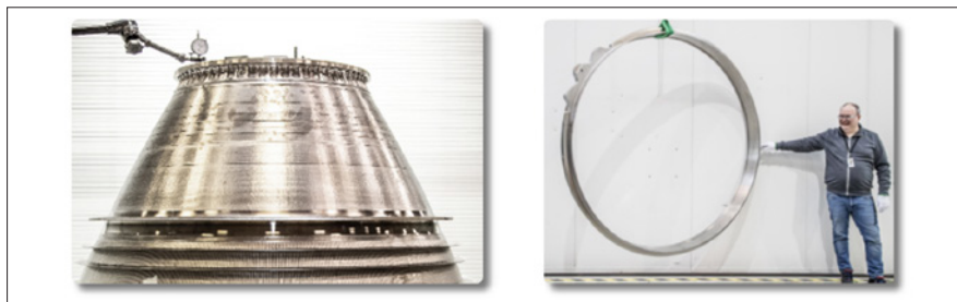
Raketmotormunstycke och fläkthusring till flygmotor tillverkade med additiv tillverkning.
