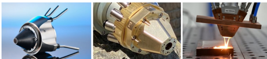
Pulvermunstycken med koaxiell pulvermatning; Ringmunstycke, multijetmunstycke och bredstrålemunstycke.
