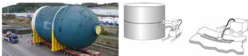
Figur 5. Även om det finns stora vakuumkammare för EBW att tillgå idag rymmer de inte tryckkärl av dimensionen t.h. Därför har CVE utvecklat en mobil utrustning för lokal elektronstrålesvetsning vars kammare kan evakueras på under sex minuter.
