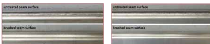
Figur 54. Takskarven svetsad med 6 kW lasereffekt och 100 mm/sek, och med Helium som skyddsgas t.v. eller Argon t.h. visade sig inte ge några visuella kvalitetsskillnader.
