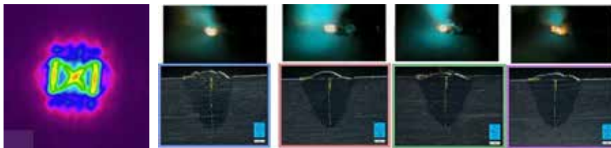
Figur 15. Svetsning av aluminium AA3003 och en timglas-formad energifördelning med olika frekvenser, fr.v. 10, 100, 150 och 200 kHz, där 150 kHz visade sig ge en i det närmaste helt sprutfri process.
