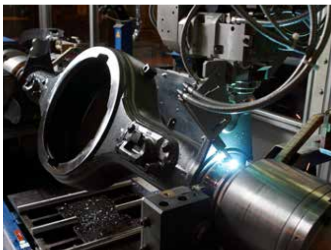
Figur 2. Lasersvetsning av bakaxelbrygga i roterande fixtur.
