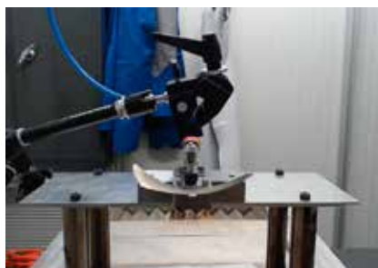
Figur 60. Även dubbelkrökta ytor går att forma med lasertekniken, och för det ändamålet har ett unikt simuleringsprogram tagits fram vid Aalborg University.
