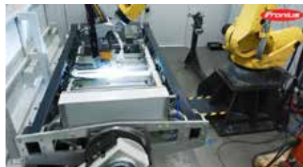
Figur 33. Inmätning och laserhybridsvetsning av batteriramar där laserstrålen oscilleras med 100 Hz i ett cirkelmönster för att säkerställa svetsgeometrin vid variationer i positionering och spalter.
