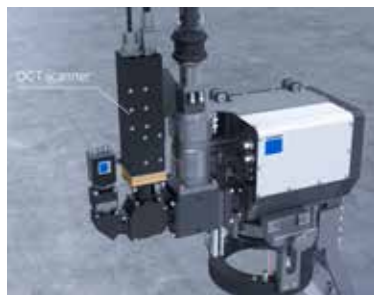
Figur 42. Trumpfs OCT-modul kan enkelt integreras i företagets skanner-verktyg PFO33.
