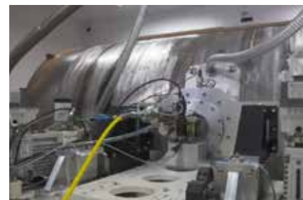
Figur 7. En installation för lasersvetsning under lokalt vakuum utvecklas nu vid CVE.
