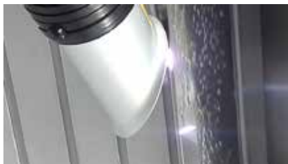
Figur 26. Med Trumpfs pulsade TruMicro7060 -laser går det utmärkt att rengöra ytorna på de bipolära plattorna till bränsleceller så att man inte riskerar att få otäta fogar vid den efterföljande lasersvetsningen.
