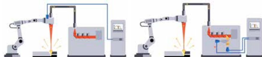
Figur 48. Sensormodulen (markerad i blått) kan integreras i såväl verktyg (t.v.) som laserkälla (t.h.). Det senare är att föredra ur tillförlitlighetssynpunkt.
