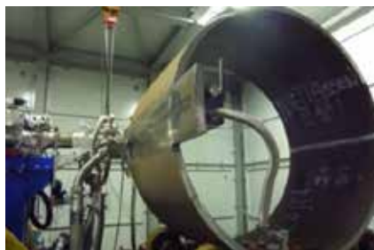
Figur 6. Att EB-svetsa CMn-cylindrar med 80 cm diameter tar cirka 6 minuter med s.k. lokalt vakuum.
