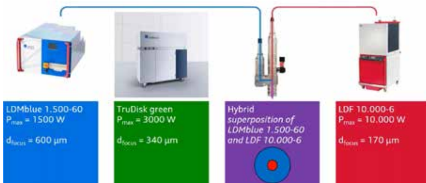
Figure 2. Tre olika laserkällor och ett hybrid-arrangemang hade använts vid lasersvetsning av kopparlegeringen Cu-PHC.
