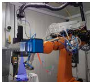
Figur 59. Stort intresse vid EALA-konferensen väckte detta multi-verktyg med en optiklösning som gör det möjligt att växla mellan olika laserprocesser.
