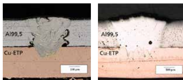
Figur 30. En tvärsnittsanalys av dessa blandfogar mellan aluminium och koppar visar ingen nämnvärd skillnad om de svetsas med kontinuerlig laser-effekt (närmast) eller med nanosekund-pulser. Dock behövs mindre medeleffekt i det senare fallet.
