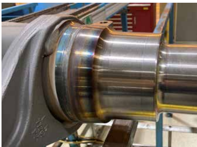
Figur 3. Axeltapp lasersvetsad ihop med bakaxelbrygga.
