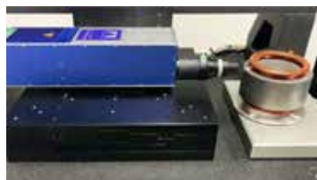
Figur 36. Tre kommersiella mätverktyg från Precitec; fr.v. en linjeskanner (CLS, en kromatisk kamera (CVC) samt punktsensorn FSS.
