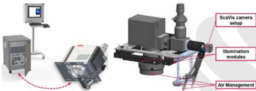
Figur 18. T.v. komponenterna som ingår i Blackbirds maskininlärningssystem för svetsning av elektriska komponenter till bildindustrin; skanner-verktyg samt kontrollenheter för detta och robot. T.h. en schematisk skiss av företagets skanner-verktyg med integrerad "ScaVis"-kamera.
