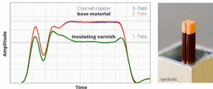
Figur 50. Sensorsignalen kan indikera hur väl "hårnålarna" rengjorts, och vi ser att vid endast en sekvens med laserpulser sitter en stor del av isoleringen kvar (grön kurva).
