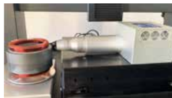
Figur 36. Tre kommersiella mätverktyg från Precitec; fr.v. en linjeskanner (CLS, en kromatisk kamera (CVC) samt punktsensorn FSS.
