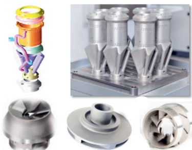
Bild 20. Nyttillverkning med AM av den nedre delen av brännaren ersätter 13 komponenter. T.h. Den övre delen av brännare repareras. Foto: Siemens
