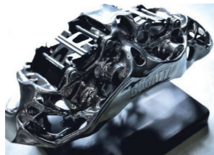
Bild 14. Bromsok med åtta kolvar utvecklad av Bugatti och tillverkad hos Fraunhofer IAPT
