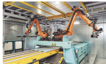
Figur 4. Industrirobotar griper och staplar de utskurna plåtämnena. Om klipplinjerna är placerade på ett sådant sätt att någon robothantering av ämnena inte krävs, skickas dessa direkt till staplingstransportörerna.
