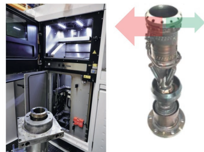
Bild 20. Nyttillverkning med AM av den nedre delen av brännaren ersätter 13 komponenter. T.h. Den övre delen av brännare repareras. Foto: Siemens
