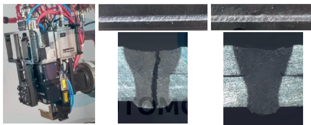
Figur 40. Överlappssvetsning av aluminiumlegeringen AA6082 utförd med Scansonics skanner-verktyg RLW-A och konventionell respektive ARM-baserad energifördelning. Med den senare (t.h.) kan man svetsa helt sprickfritt även då svetsen positioneras mycket nära plåtkanten.
