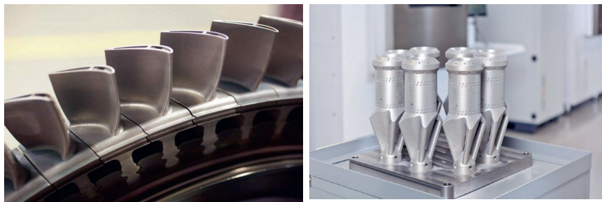
Figur 5. 3D-printade turbinblad (t.v.) och brännarmunstycken (t.h.) hos Siemens, som redan idag använder den additiva metoden LMD för reparation av de senare.
