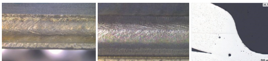
Figur 20. Efterföljande omsmältning med 400 Hz pendlingsfrekvens jämnar ut svetsfogen och ger därmed ett bättre kvalitetsintryck.
