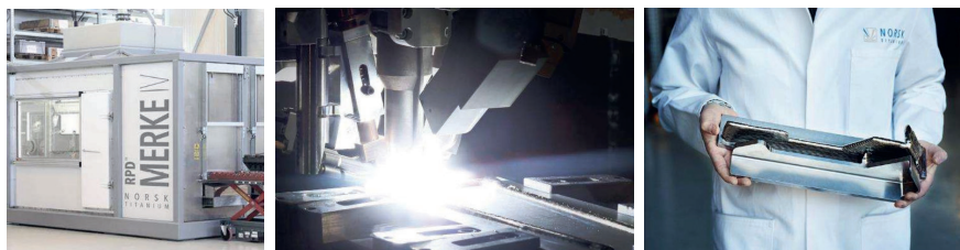
Figur 6. T.v. en G4-cell hos Norsk Titanium för tillverkning med s.k. Rapid Plasma Deposition där två ljusbågar arbetar simultant. 2017 fick man ett godkännande från FAA (Federal Aviation Administration) att tillverka komponenter i Titan för Boeings "787 Dreamliner".
