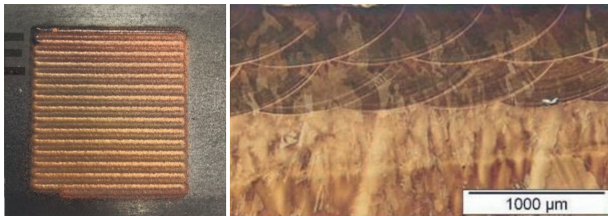
Figur 7. Applicering av ett kopparskikt på en yta med hjälp av en blå laser.
