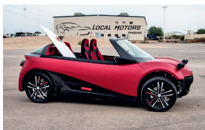
Bild 15. 3D-printad körduglig bil från Local Motors, Phoenix, USA. Målet i framtiden är att 90 % av karossens vikt ska vara 3D-printad.
