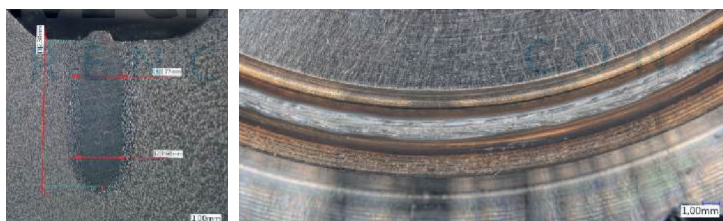
Figur 41. Med "CleanWeld"-tekniken går det också att skapa svetsar med ett rektangulärt tvärsnitt, något som kan vara önskvärt ur hållfasthetssynpunkt vid lasersvetsning av transmissionskomponenter.
