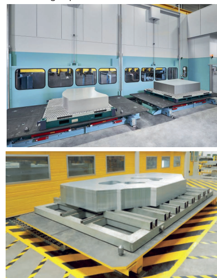
Figur 3. De utskurna plåtämnen staplas och arrangeras för vidare transport till efterföljande formningsoperationer.
