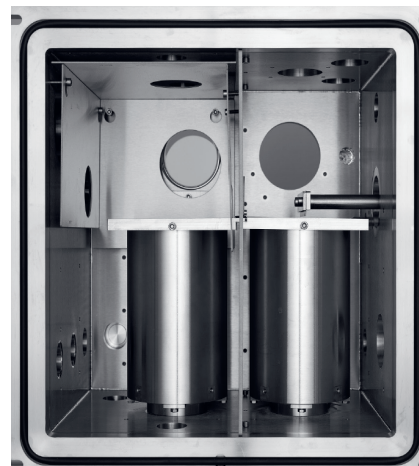
Figur 13. "Freemelt One" är en s.k. open source med vars hjälp en potentiell användare av additiv tillverkning kan undersöka nya pulvermaterial, optimera pulverflödet samt skräddarsy exklusiva rörelsemönster för elektronstrålen. Detta understöds av att höghastighetskamera eller andra övervakningsinstrument kan integreras i maskinen.
