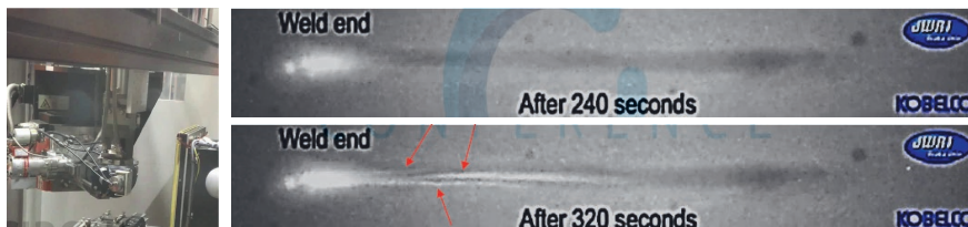
Figur 34. Genom att utföra långa lasersvetsar fördröjs sprickinitieringen! Röntgenfotona ovan visar på inga sprickor efter 240 sekunders kontinuerlig svetsning, utan dessa uppstår först efter 320 sek. T.v. ses den uppställning som användes vid försöken på JWRI.
