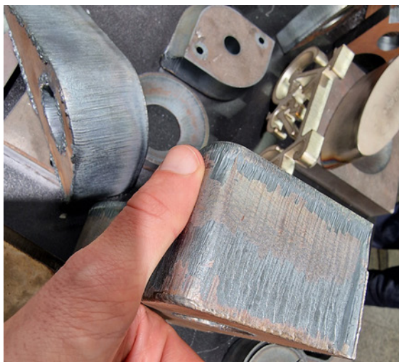
Figur 4: Exempel på skurna detaljer med 30kW fiberlaser hos Intercut. Till vänster 55mm tjockt kolstål och till höger exempel på snitt med lutande laserstråle.
