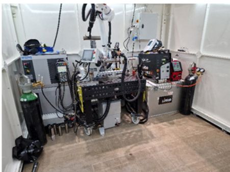
Figur 6: Handhållen lasersvetsning demonstrerades i ny säker arbetscell av LMAB. I denna cell visades IPGs LightWeld XC (ännu enda systemet i Europa som är CE-godkänt), här visades också alternativt med en robot som hållare för svetspistolen.
