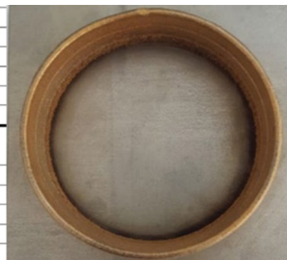
Figur 1: Analys av förbrukning för ett cylindriskt aluminium-brons rör, additiv tillverkad med DED-EB (elektronstråle) jämfört med DED-LB (laserstråle).
