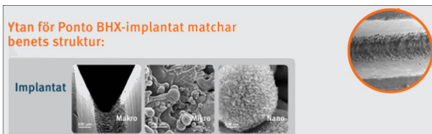
Bearbetning på medicinska implantat av titan. Önskad struktur syns bäst i mittersta bilden. (Oticon Medical)
