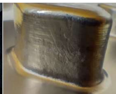
L-DED-w (Laser metal deposition) bossarna tillverkas på plats i laserstationen, och svetsas lager för lager direkt på plåtsvepet med laser och tråd.
