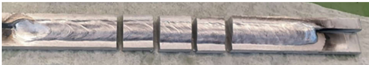
Figur 4: Uppdelning av svets för LOM-provtillverkning.
