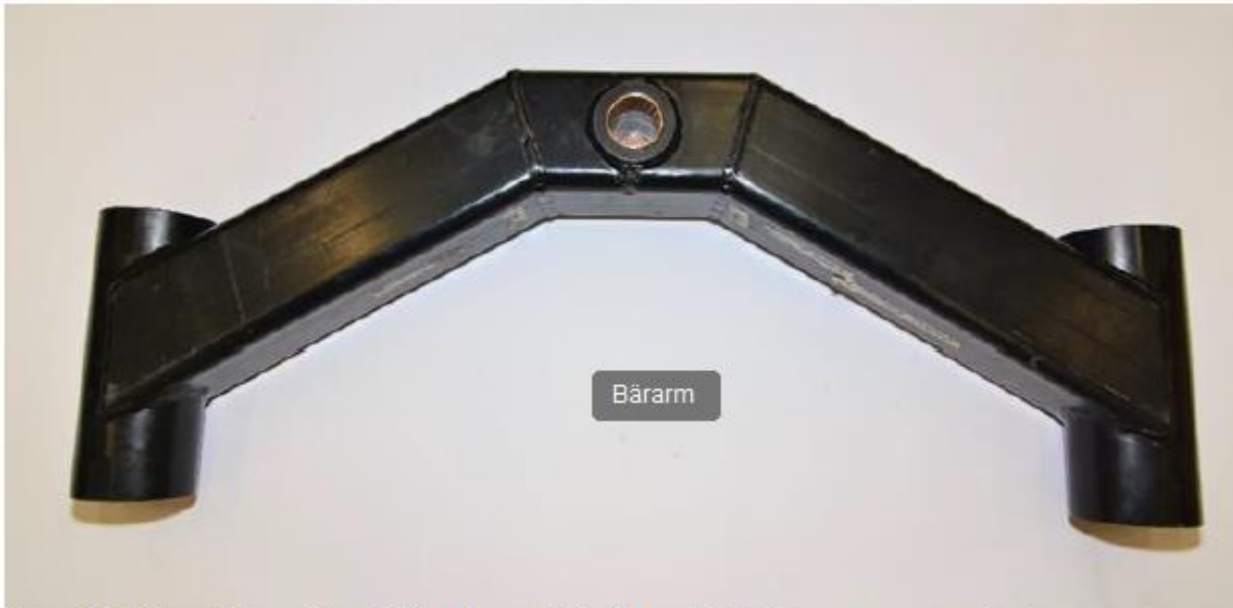
Figur 8. En främre bärarm till ett Jetline-tåg med hålet för axelfästningen mot vagnen i mitten.
