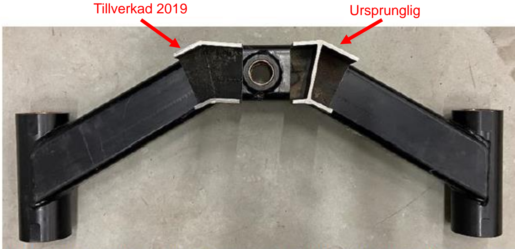
Figur 19. Bilden visar en bärarm med utsågade prover lagda ovanpå. Provet till vänster är från en bärarm tillverkad 2019 och till höger från en ursprunglig bärarm. Den tvärställda plåten som saknas i den vänstra syns i den högra delen.
